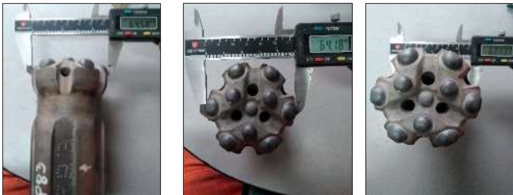
Figura 25. Medición del desgaste de la broca según la clasificación del tipo de roca evaluada de la broca Retráctil faldón corto T38 X 64 milímetro respecto al año 2018
