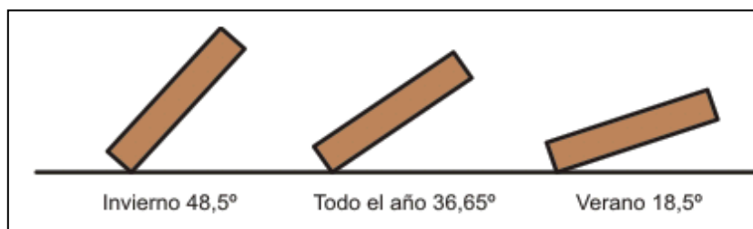
Figura 13: Inclinación de las placas solares fotovoltaicas
