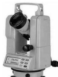
**Figura 26:** Teodolito electrónico
