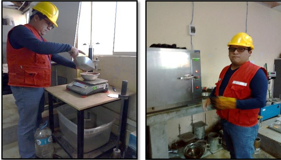
Figura 29: Pesado de las muestras y secado en el horno.
