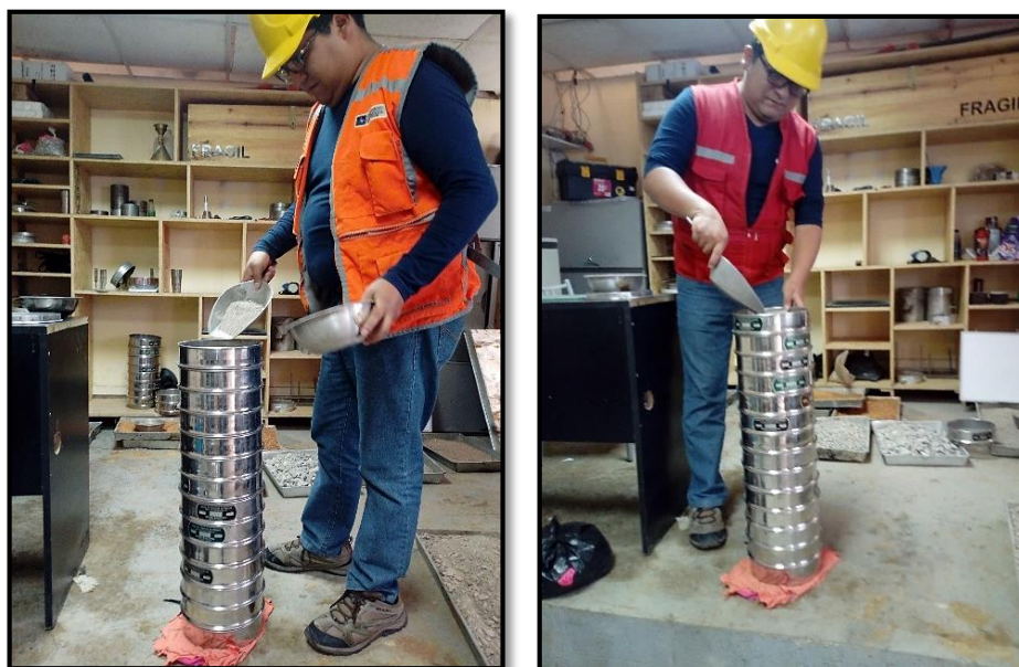
Figura 42: Análisis granulométrico por tamizado de las muestras.
