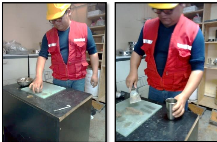
Figura 32: Realizando el ensayo de límite plástico, formado de cilindros para secar en el horno.
