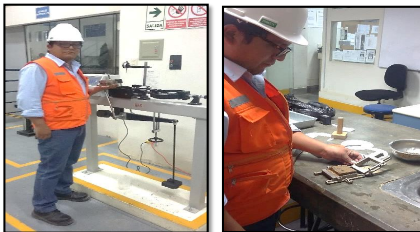
Figura 33: Ensayo de corte directo y muestras ensayadas.
