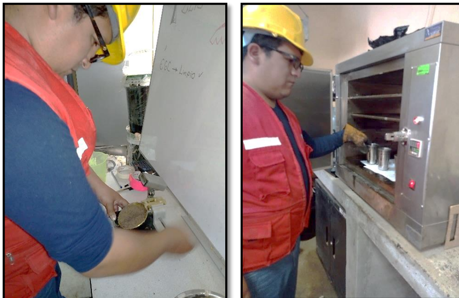
Figura 43: Ensayos de límite líquido.
