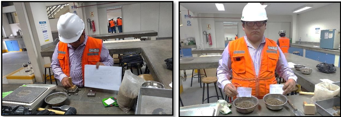
Figura 47: Preparación de especímenes para el ensayo de corte directo +% cemento.
