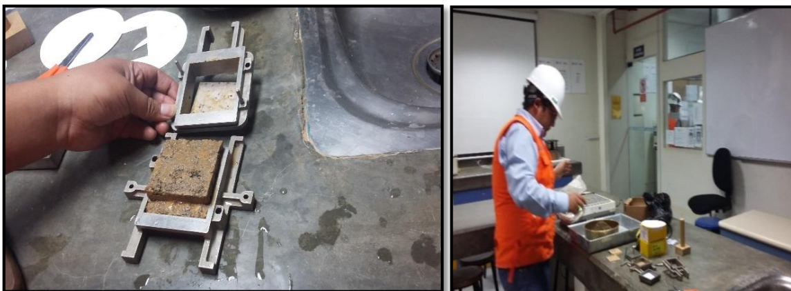
Figura 45: Preparación de especímenes para el ensayo de corte directo-sin adición.
