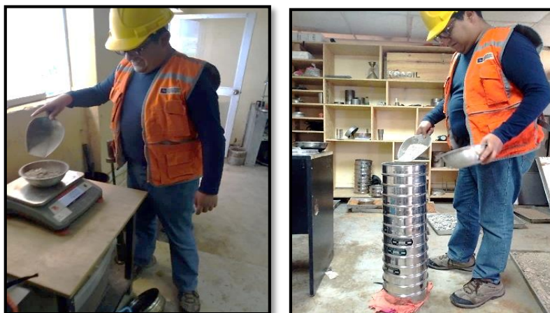
Figura 30: Pesado del material y el proceso de tamizado.
