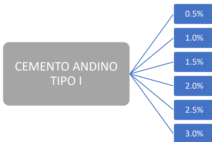
Figura 37: Flujograma de la mezcla del afirmado con dosis de cemento andino tipo I.
