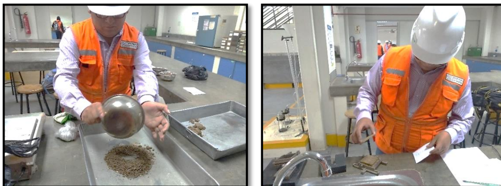
Figura 38: Realización del espécimen con adición de cemento andino tipo I para ser ensayada.
