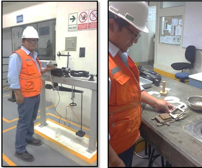
Figura 49: Muestras ensayadas con el equipo de corte directo.
