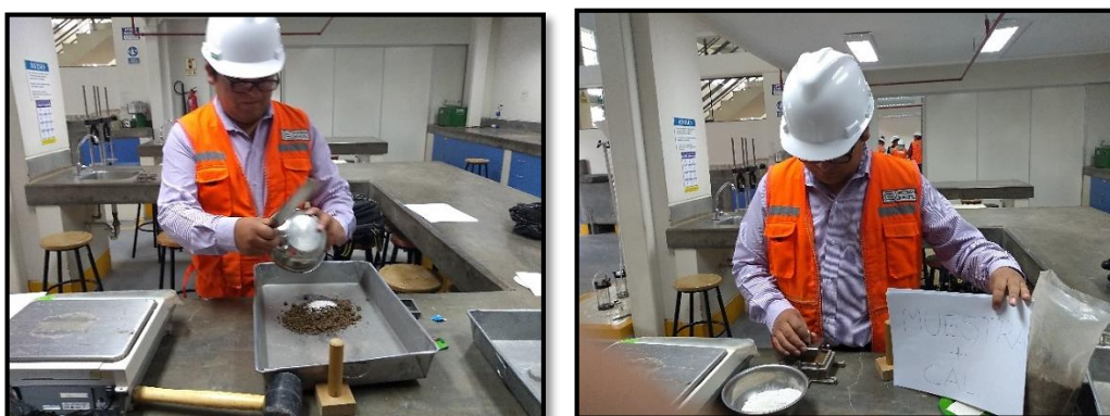
Figura 36: Elaboración de especímenes con adición de cal para ser ensayada.
