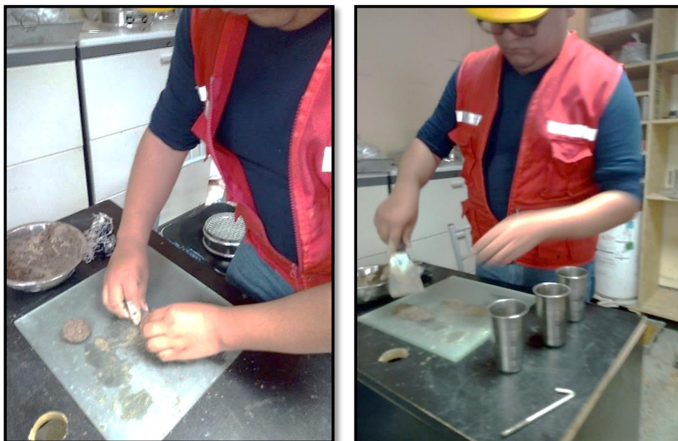
Figura 44: Ensayos de límite plástico.
