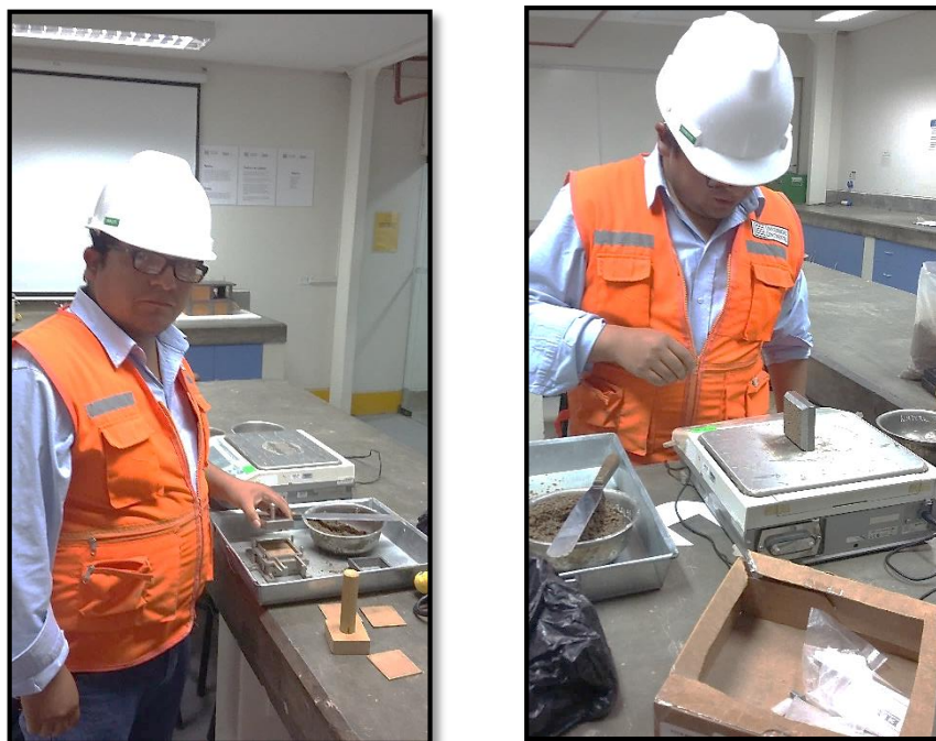
Figura 48: Preparación de la caja de corte para realizar el ensayo de corte directo.
