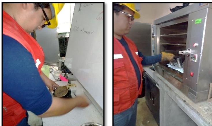
Figura 31: Realizando el ensayo de límite líquido y secado para pesar.
