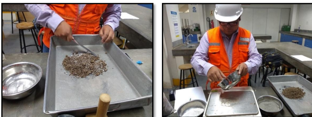
Figura 46: Preparación de especímenes para el ensayo de corte directo +% cal.
