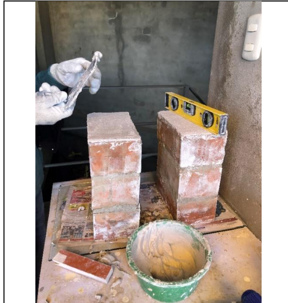
Figura 40. Aplicación del capping de cal. Fuente: Propia.
