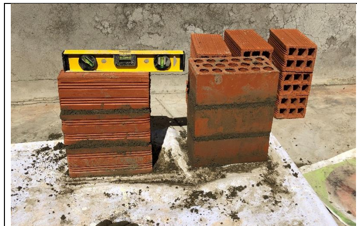
Figura 39. Construcción de pilas de albañilería. Fuente: Propia.
