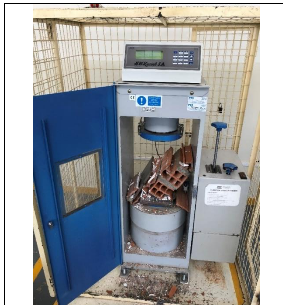
Figura 43. Ensayo en pila de albañilería de ladrillo pandereta.
