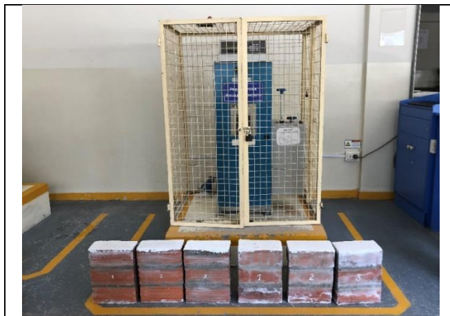
Figura 41. Pilas de albañilería. Fuente: Propia.
