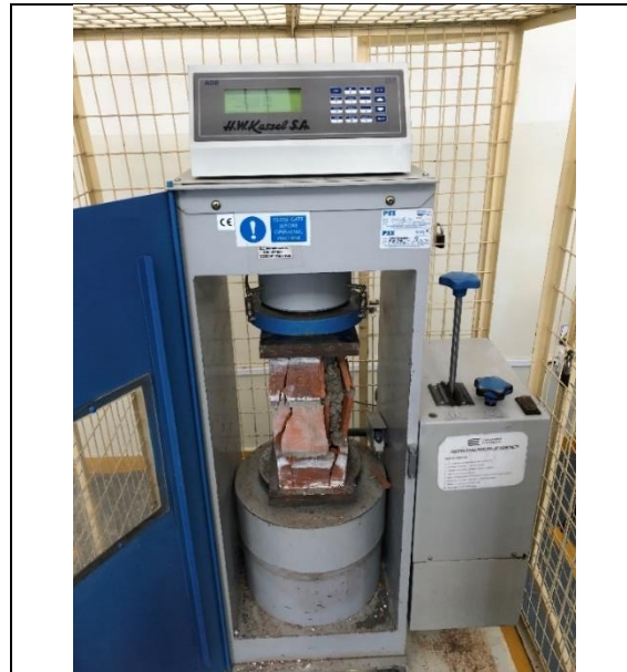
Figura 42. Ensayo en pila de albañilería de ladrillo King Kong 18 huecos.
