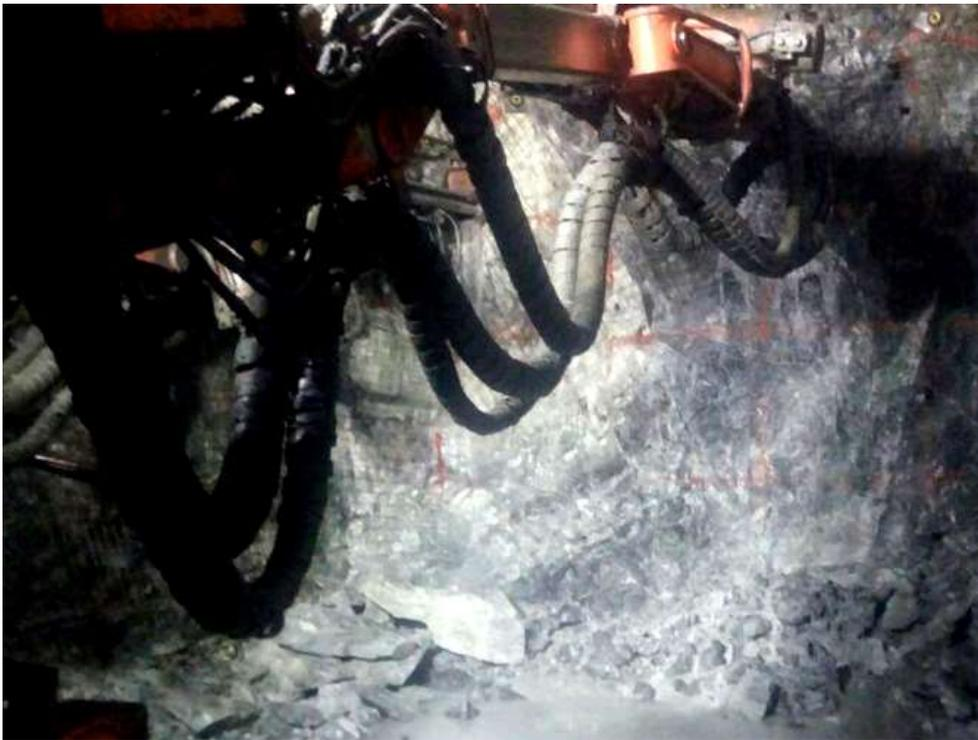
*Perforación y laboreo con Jumbo Hidráulico en GL-9800*
