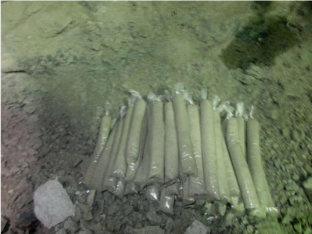
*Aplicación de Taco Inerte como factor de mejora de aprovechamiento de energía para la fragmentación del material volado.*
