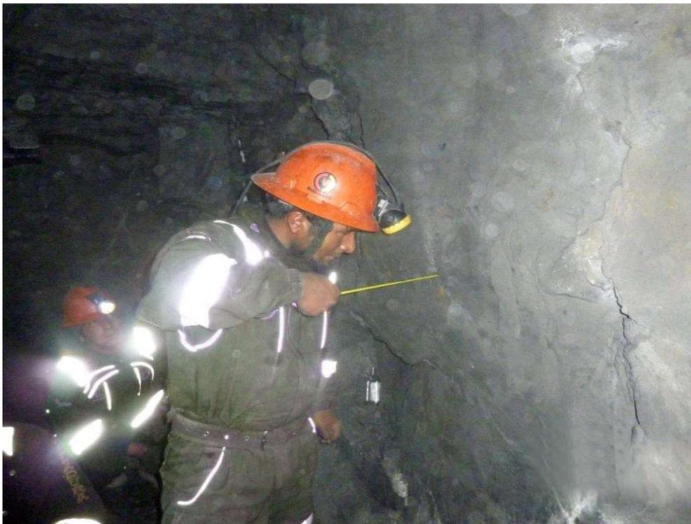
*Control de Longitud de Carga Explosiva y evaluación de "Atacado".*
