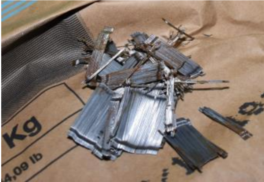
Figura 12. Fibras metálicas oxidadas
