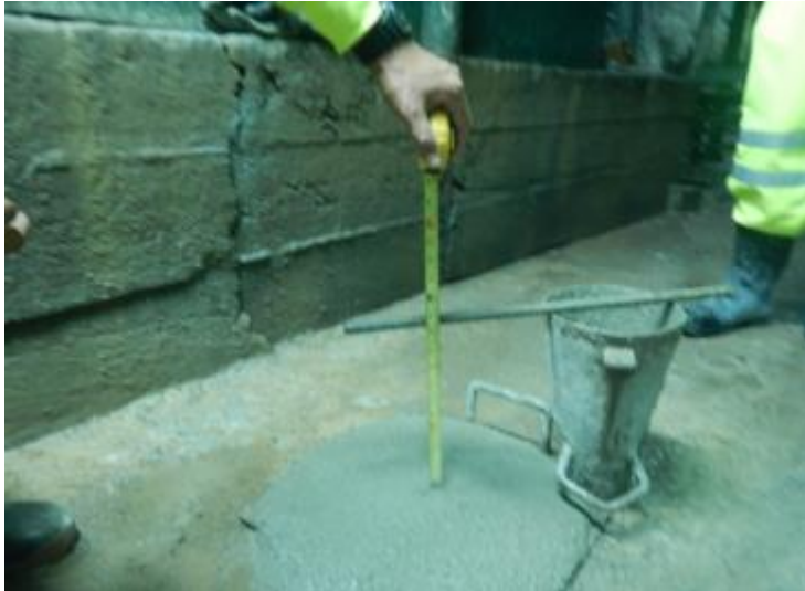
Figura 14. Slump obtenido en el mezclado en mixer
