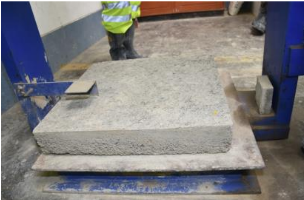
Figura 10. Panel de ensayo a flexión con rebote atrapado en su ejecución
