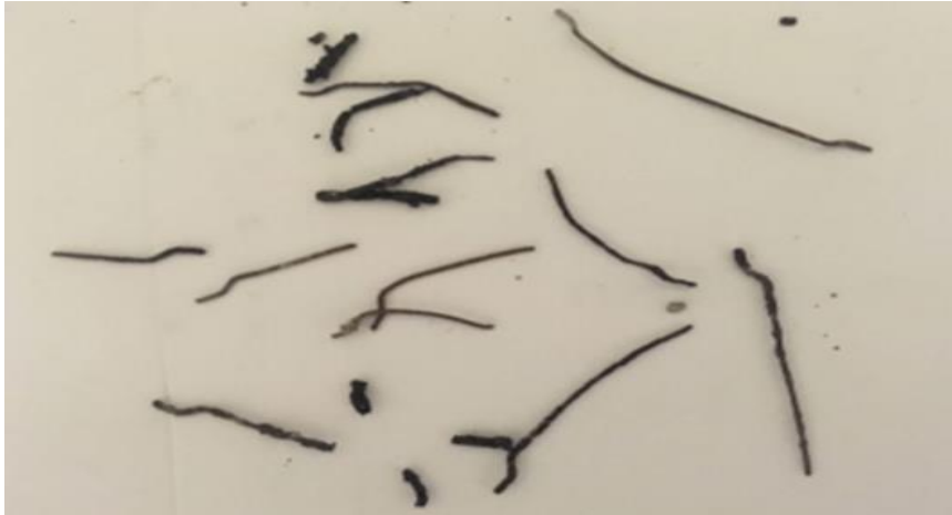
Figura 43. Diferentes grados de corrosión de las fibras
