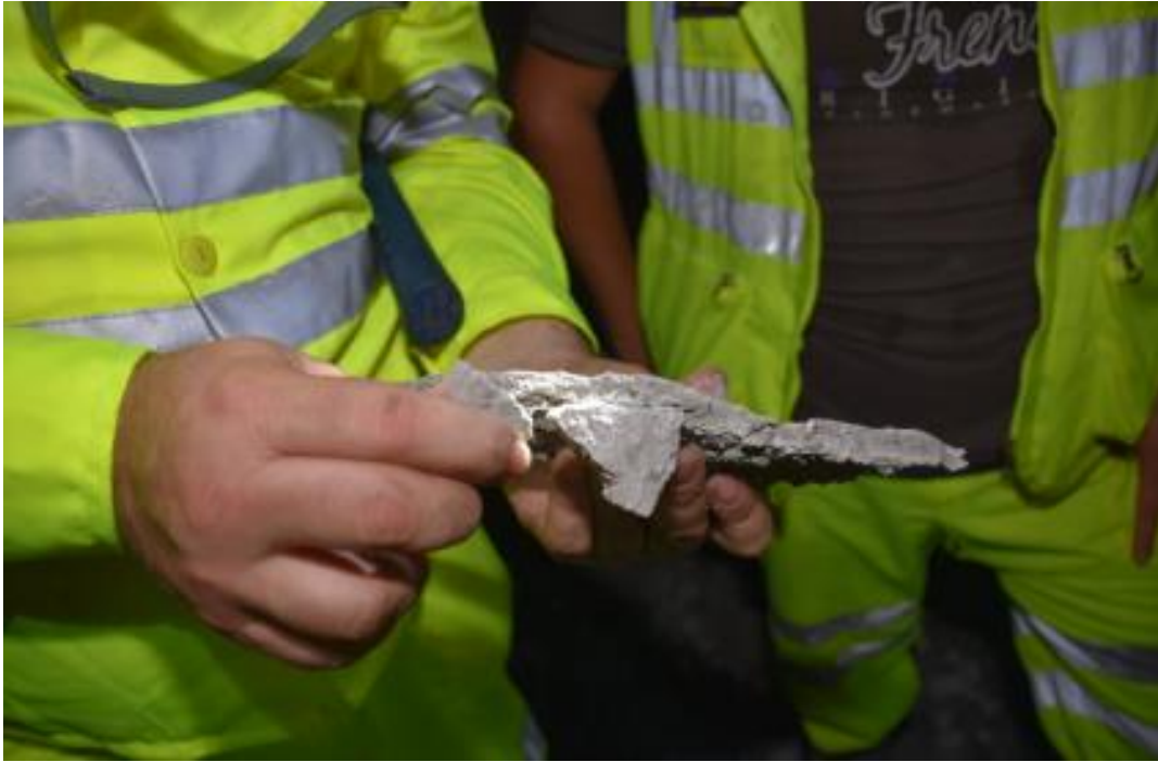
Figura 9. Espesor aplicado menor al exigido
