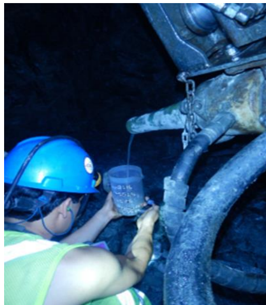
Figura 29. Toma de muestra para determinar la densidad del aditivo
