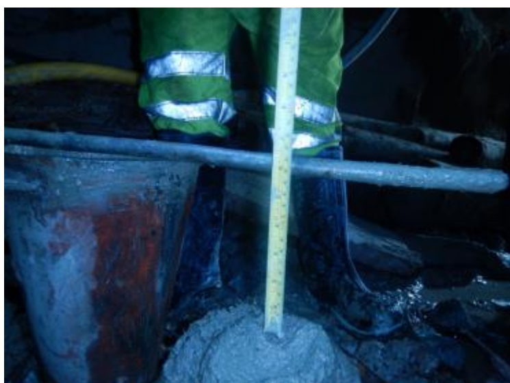
Figura 19. Ejemplo de otra mezcla con slump 5 ¾”
