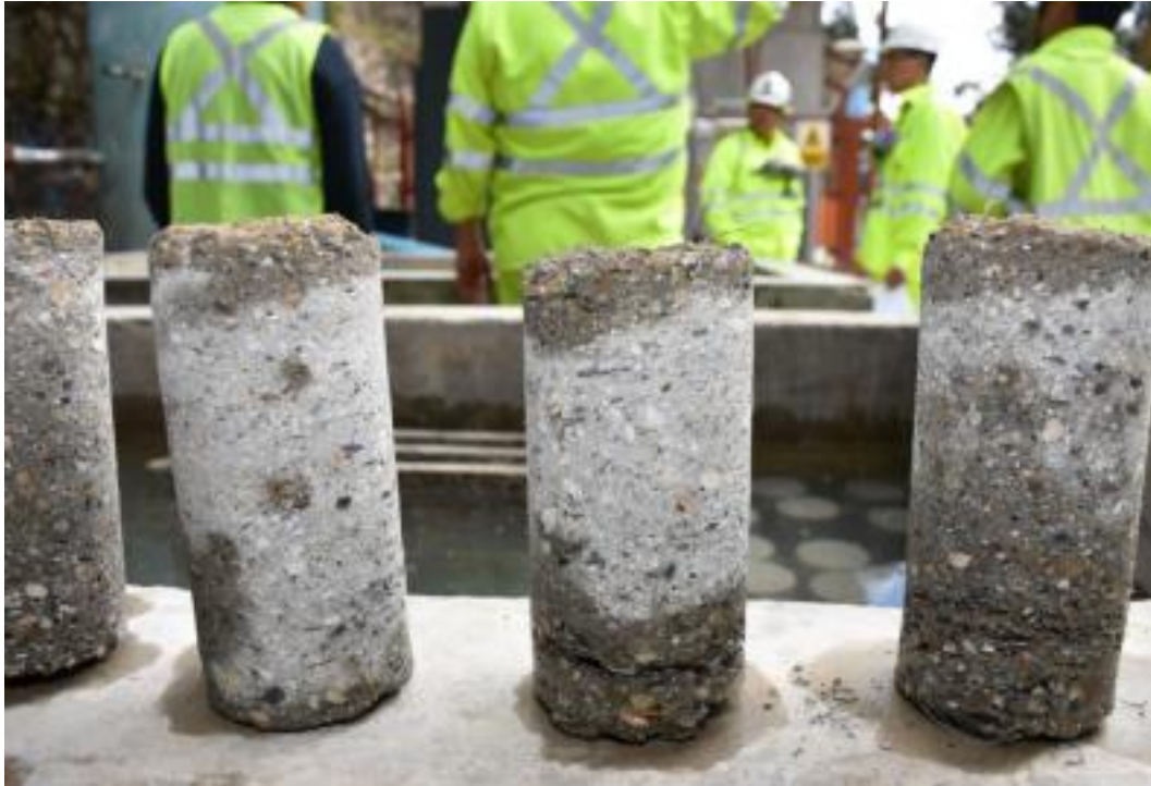
Figura 11. Probetas cilíndricas para ensayo de resistencia con layering
