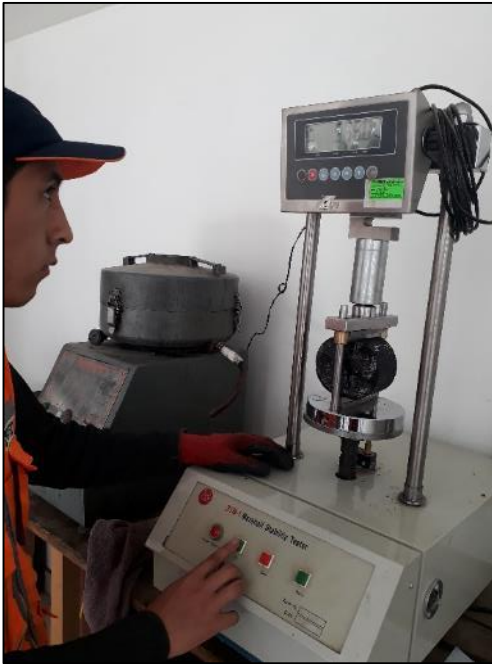
Fotografía N° 22: Subgrupo seco ensayado con la mordaza Lottman en la máquina de carga a compresión.
