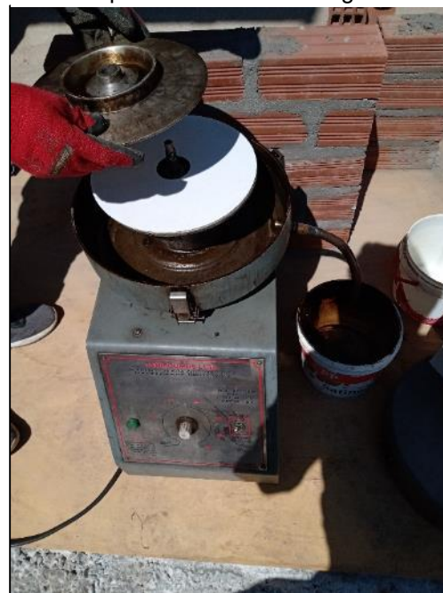
Fotografía N° 8: Colocación del espécimen en la centrifuga.
