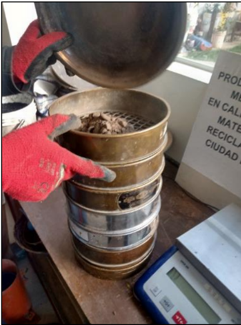
Fotografía N° 2: Tamizaje del material reciclado.
