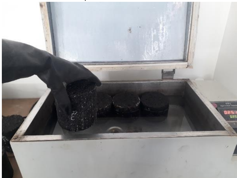
Fotografía N° 29: Especímenes colocados en el baño de agua por 4 horas a 25 °C.
