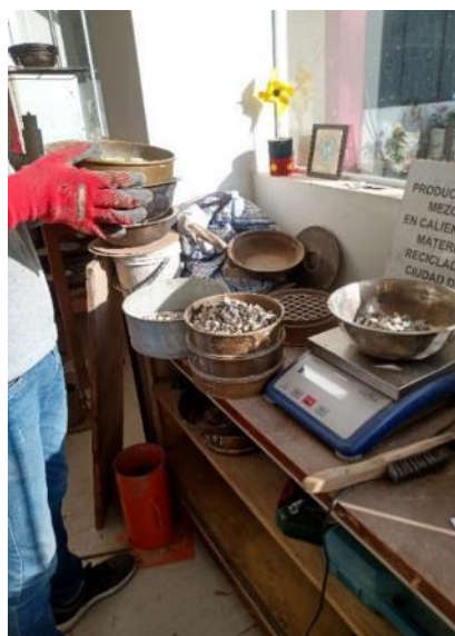
Figura 21. Proceso de tamizaje del agregado grueso
