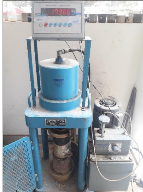
Fotografía N° 12: Compactación de la mezcla con una carga de 17360 kgf.
