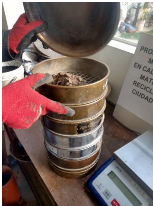
Figura 20. Proceso de tamizaje del material reciclado
