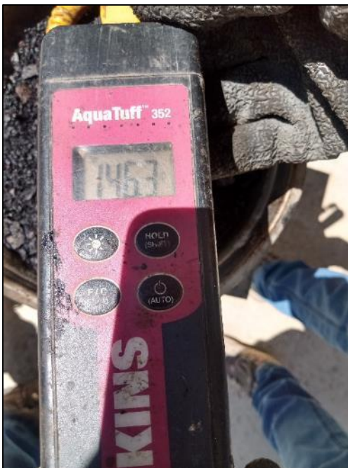
Fotografía N° 7: Control de la temperatura de mezclado.
