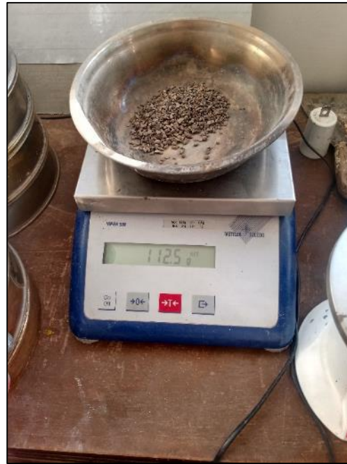
Fotografía N° 12: Pesado del material retenido en el tamiz.
