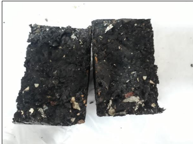
Fotografía N° 23: Fractura de los agregados despues del ensayo de tracción indirecta (Subgrupo seco).
