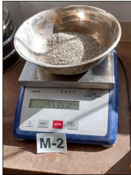
Fotografía N° 3: Pesado del agregado retenido en el tamiz.
