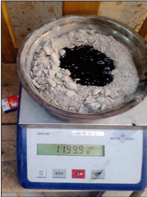
Fotografía N° 5: Pesado del agregado virgen más el líquido asfáltico.
