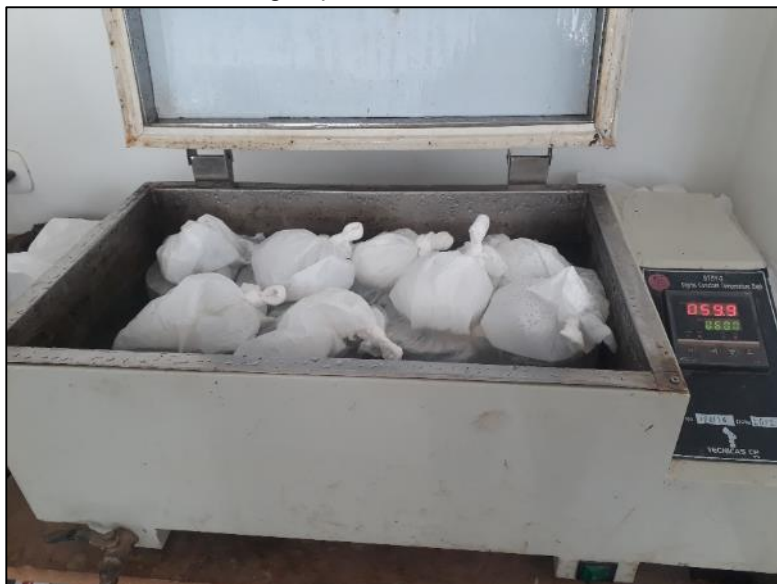
Fotografía N° 26: Subgrupo acondicionado colocado en el baño de agua por 24 horas a 60 °C.
