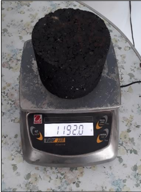
Fotografía N° 34: Espécimen antes de ser ensayado.
