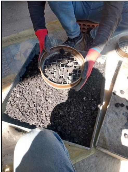
Fotografía N° 10: Tamizaje del material reciclado con la malla N° 3/4
