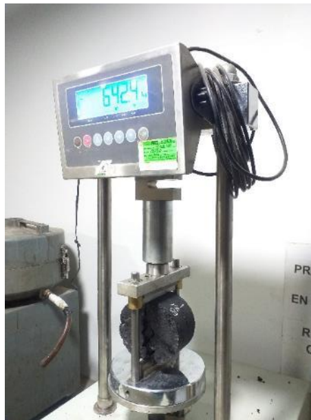
Figura 31. Subgrupo seco ensayado con la mordaza Lottman en la máquina de carga a compresión
