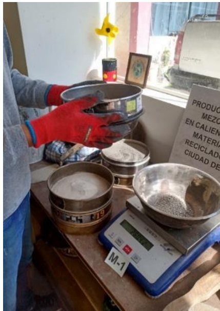
Figura 22. Proceso de tamizaje del agregado fino
