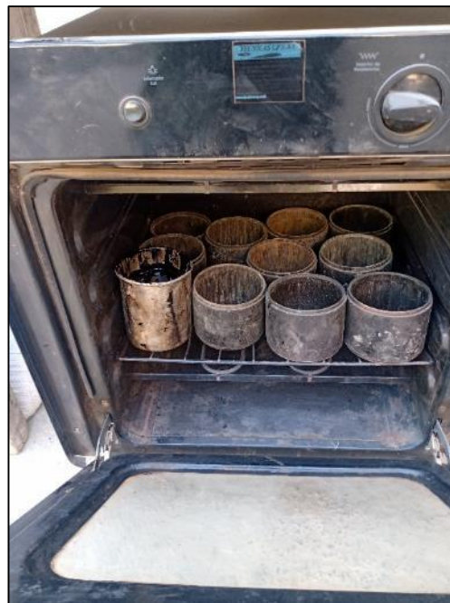
Fotografía N° 6: Calentamiento de las briquetas
