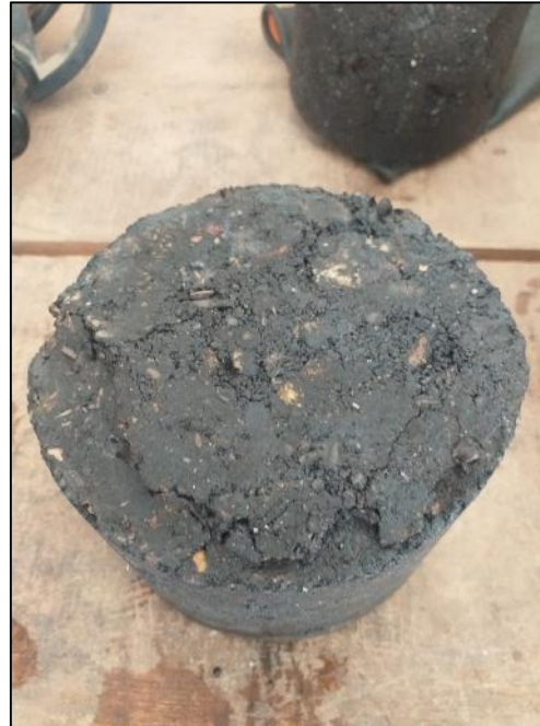
Fotografía N° 18: Espécimen después de haber sido ensayado en la Prensa Marshall.
