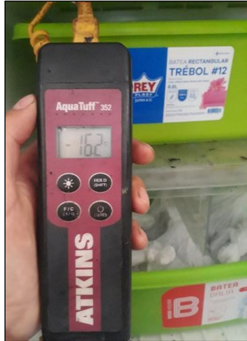
Fotografía N° 24: Subgrupo acondicionado colocado en la congeladora por 16 horas a -18 \pm 2 °C.
