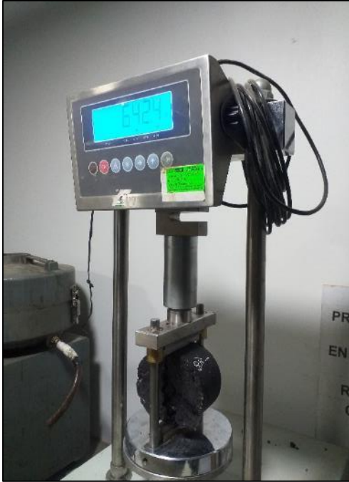
Fotografía N° 28: Subgrupo acondicionado ensayado con la mordaza Lottman en la máquina de carga a compresión (Subgrupo acondicionado).
