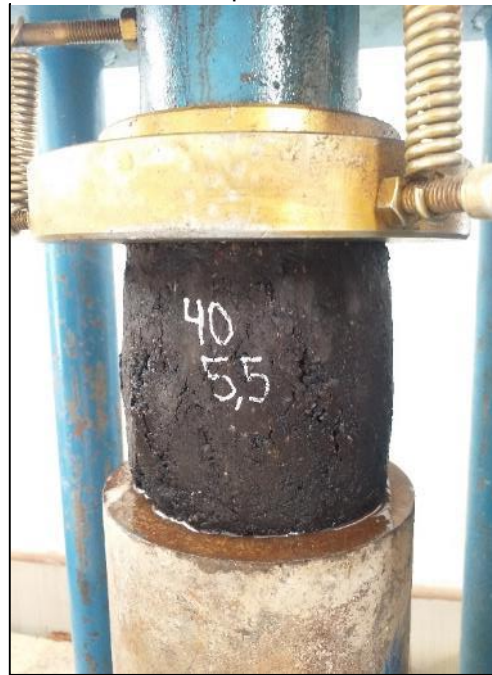
Fotografía N° 31: Falla del espécimen a compresión.
