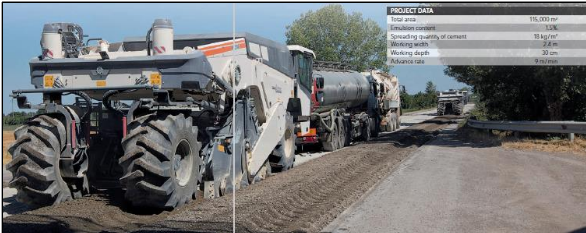
Figura 17. Máquina para el proceso de recuperación a profundidad (full-Depth)
