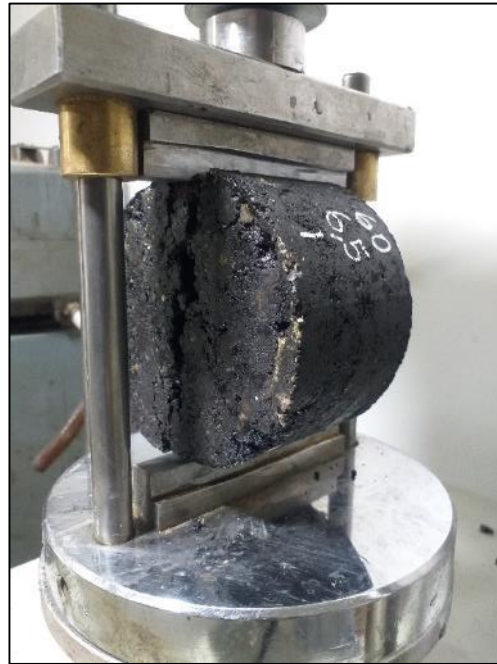
Fotografía N° 21: Falla del espécimen a tracción indirecta (Subgrupo seco).
