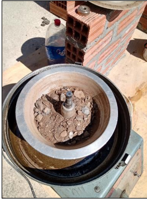
Fotografía N° 9 Fin de la extracción de asfalto del espécimen.
