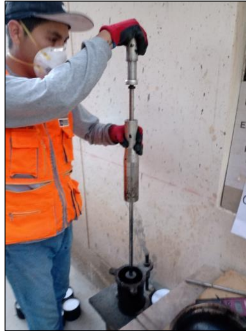
Fotografía N° 9: Compactación de la mezcla asfáltica, 75 golpes en ambas caras
