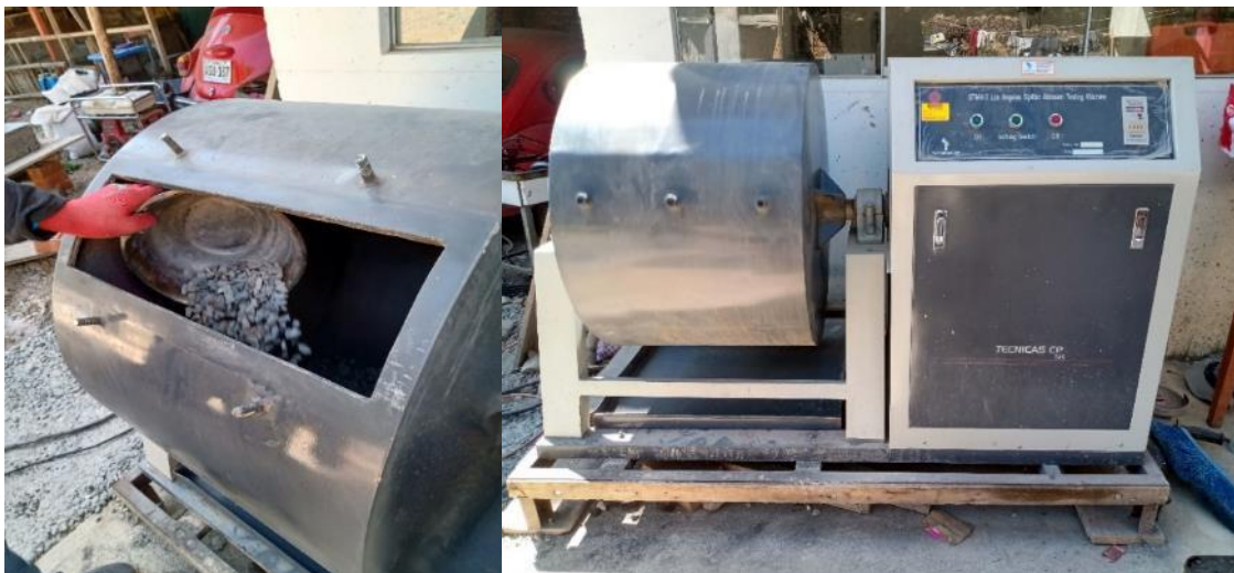
Figura 23. Ensayo resistencia al desgaste por abrasión, Máquina de los Ángeles.
