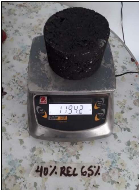
Fotografía N° 15: Pesado del espécimen.
