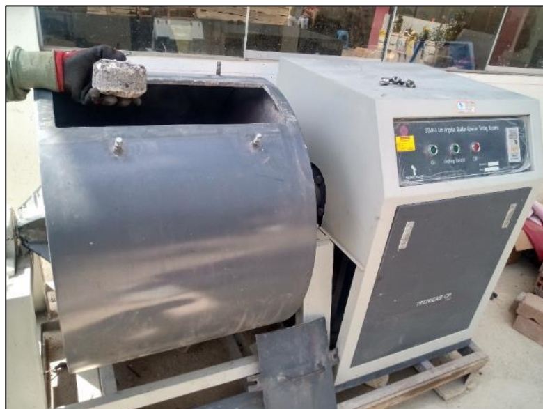
Fotografía N° 32: Espécimen ensayado en la máquina de los Ángeles.
