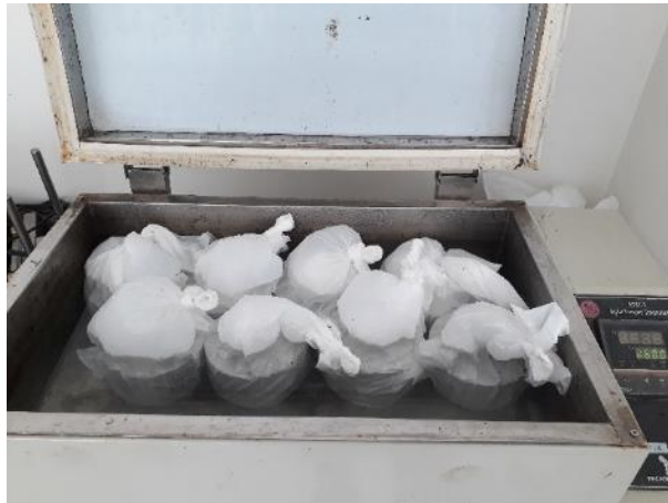
Figura 30. Subgrupo seco sumergido en el baño con agua a 25°C.
