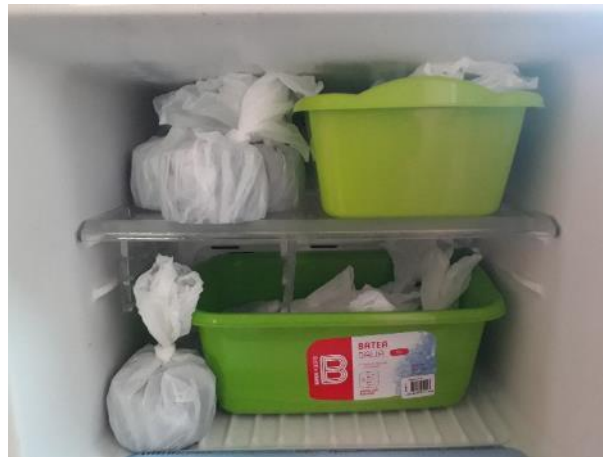
Figura 32. Subgrupo acondicionado colocado en la congeladora a -18°C.
