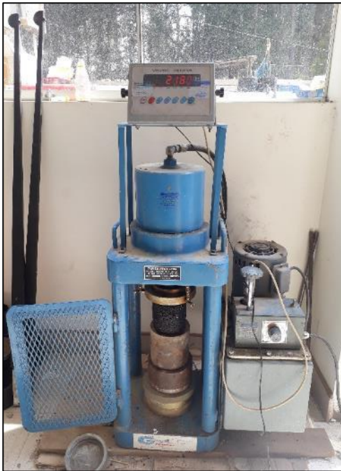
Fotografía N° 30: Espécimen ensayado en la máquina de carga a compresión.
