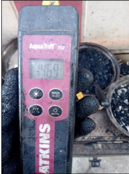
Fotografía N° 13: Control de la temperatura de compactación.
