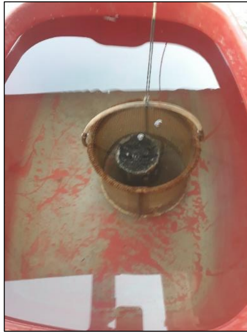
Fotografía N° 16: Peso de la Briqueta Sumergida en el Agua.
