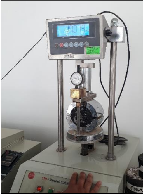
Fotografía N° 19: Medición de la estabilidad y flujo del espécimen en la Prensa Marshall.
