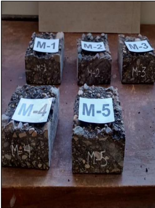
Fotografía N° 5: Especímenes de la carpeta asfáltica.
