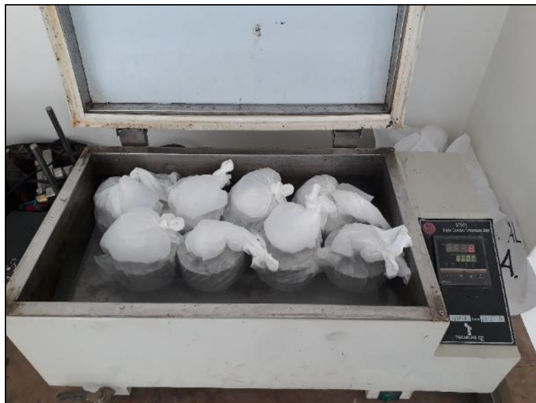
Fotografía N° 20: Especímenes del subgrupo seco sumergidos en agua a una temperatura de 25 °C por un periodo de 2 horas.
