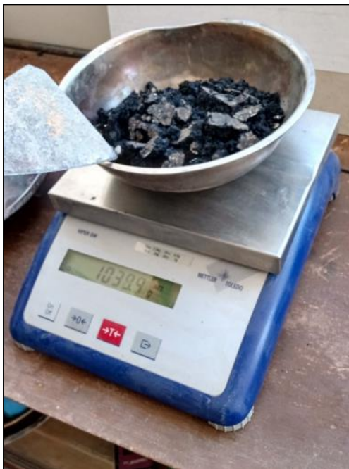
Fotografía N° 7: Pesado del espécimen.
