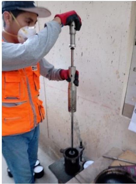
Figura 27. Compactación de la mezcla asfáltica en caliente
