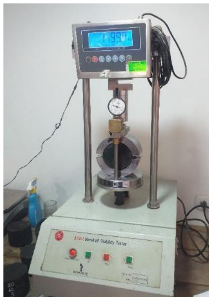
Figura 29. Ensayo de estabilidad y flujo del espécimen
