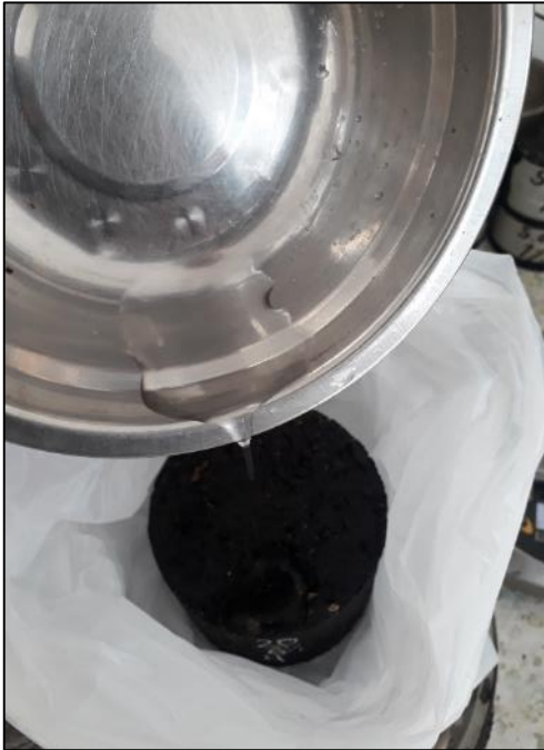
Fotografía N° 25: Adición de 10 ml. de agua en una bolsa hermética (Subgrupo acondicionado).
