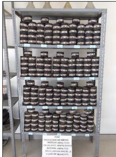
Fotografía N° 11: Especímenes elaborados con diferentes porcentajes de material reciclado.
