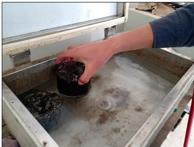
Fotografía N° 17: Especímenes sumergidos en agua a una temperatura de 60 °C por un periodo de 35 a 40 minutos.
