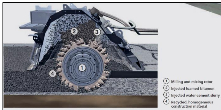
Figura 16. Sistema de recuperación a profundidad (Full-Depth)
