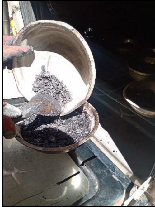
Fotografía N° 4: Proceso de mezclado del material reciclado con la nueva mezcla.
