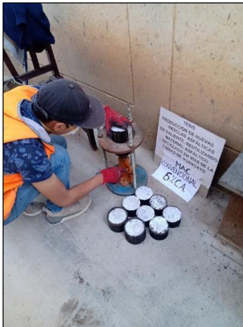
Fotografía N° 10: Extracción de los especímenes del molde.
