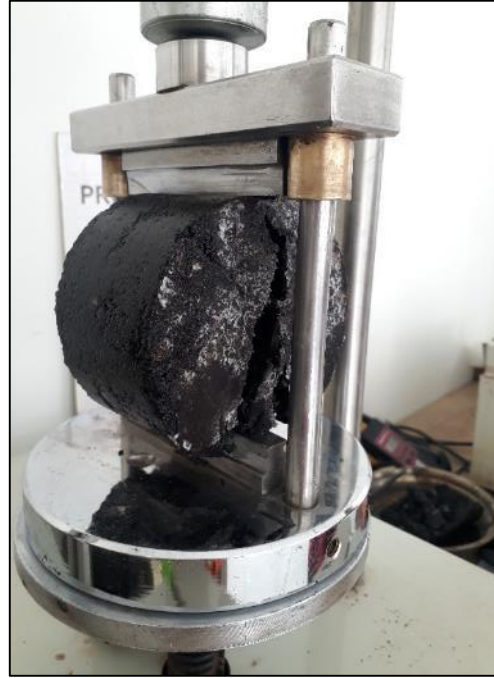
Fotografía N° 27: Falla del espécimen a tracción indirecta (Subgrupo acondicionado).
