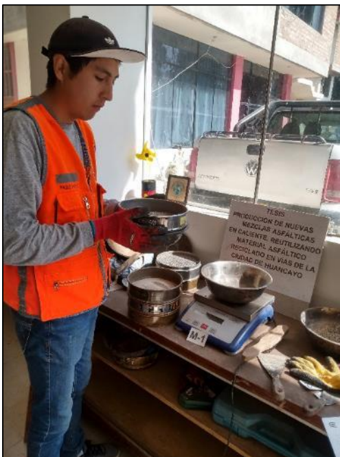
Fotografía N° 13: Tamizaje del agregado virgen.
