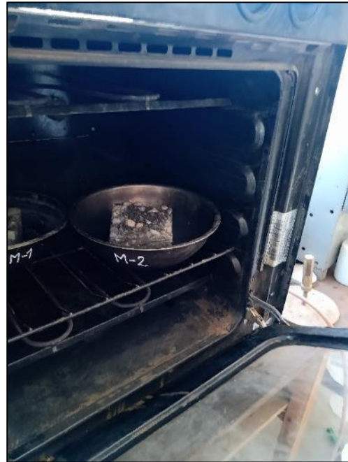
Fotografía N° 6: Especímenes puestos en el horno a 120° C.
