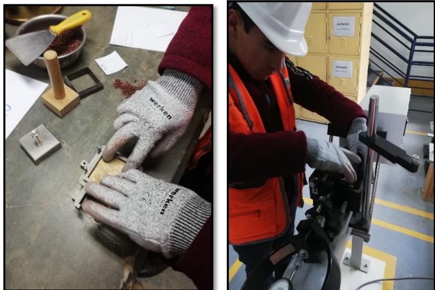
Figura 93: Preparación de especímenes para el ensayo de corte directo con presencia de raíces de pastos Vetiver.
