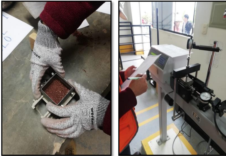
Figura 92: Preparación de especímenes para el ensayo de corte directo sin presencia de raíces de pastos Vetiver.
