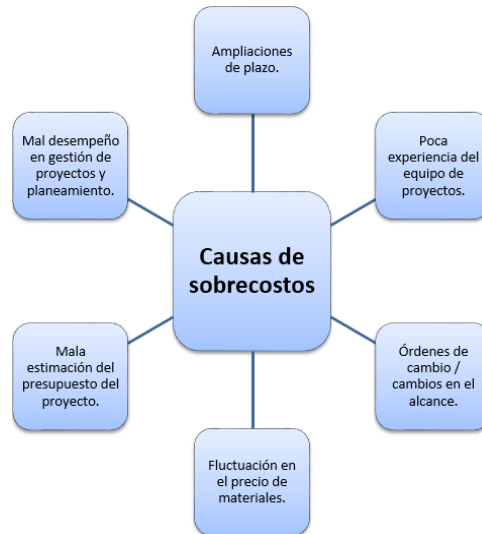
Figura 42. Causas más frecuentes y severas que influyen en sobrecostos de proyectos de construcción.
