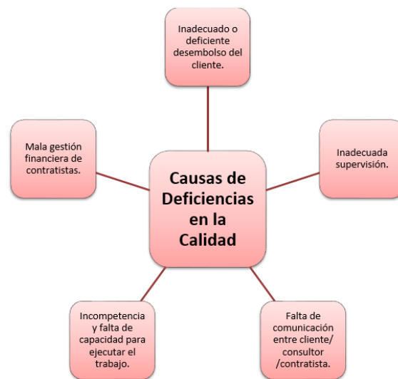
Figura 44. Causas más frecuentes y severas que originan deficiencias en la calidad de proyectos de construcción.
