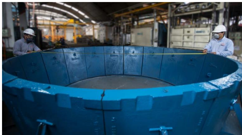
Figura 03. Fila de cóncavos para chancadora giratoria.
