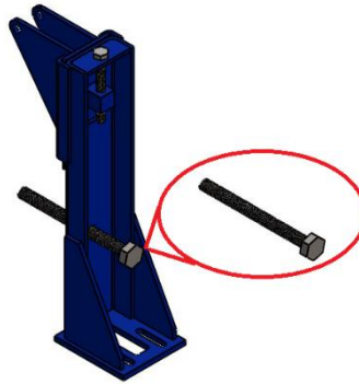
Figura 67. Tornillo vertical para movimiento del revestimiento cóncavo.
