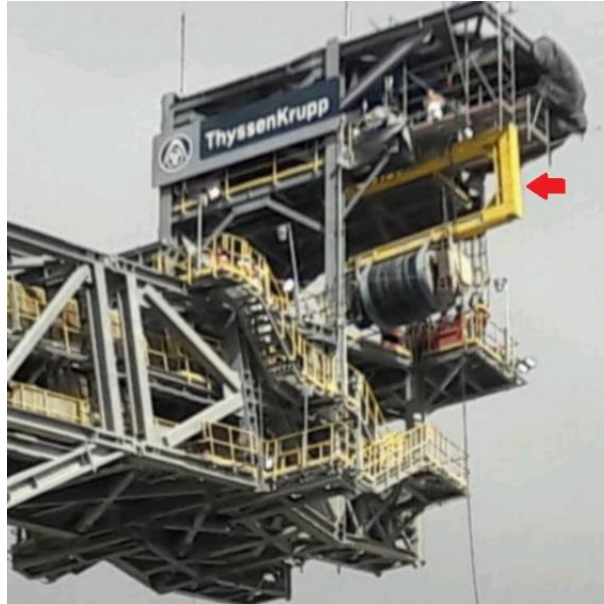
Figura 01. Aparejo para cambio de poleas.
