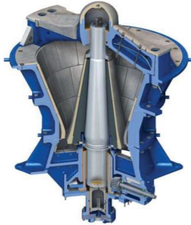
Figura 02. Chancadora giratoria 60" x 113".
