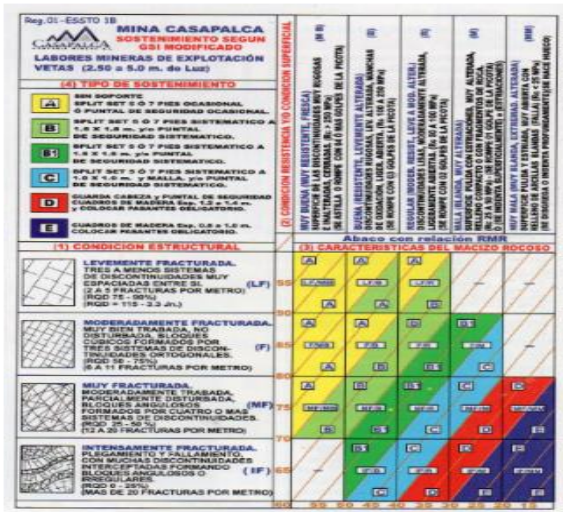
Figura 9. Cartilla geomecánica GSI. Tomada del Departamento de Geomecánica- compañía minera Casapalca S. A.
