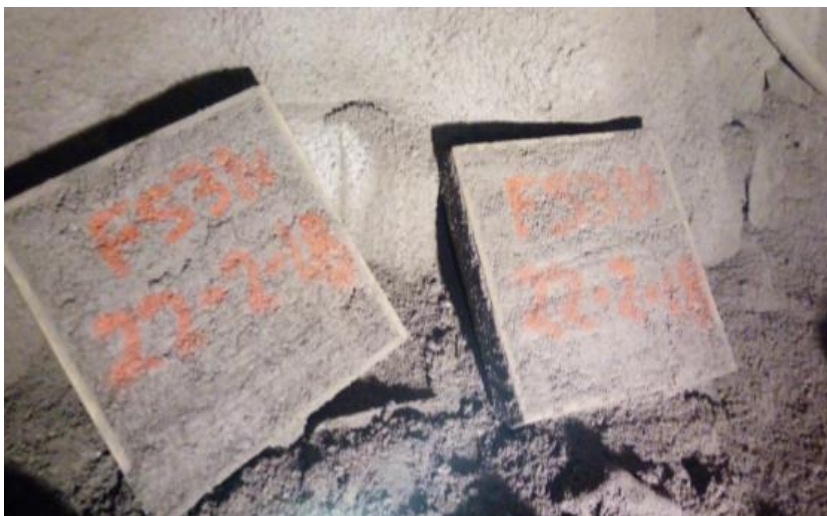
Figura 19. Muestra de shotcrete
