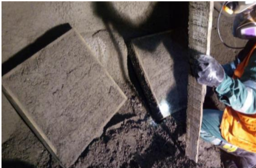
Figura 18. Preparado de muestra en la bandeja
