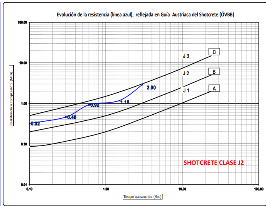
Figura 13. Clasificación del shotcrete . Tomada del Departamento de Geomecánica – compañía minera Casapalca S. A.
