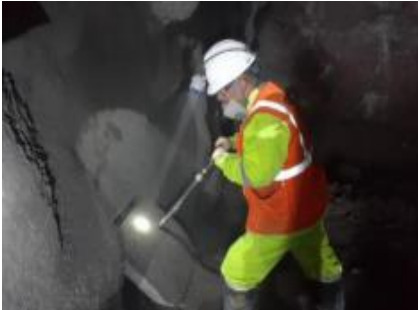
Figura 22. Método de ensayo con pistola Hilti DX 450
