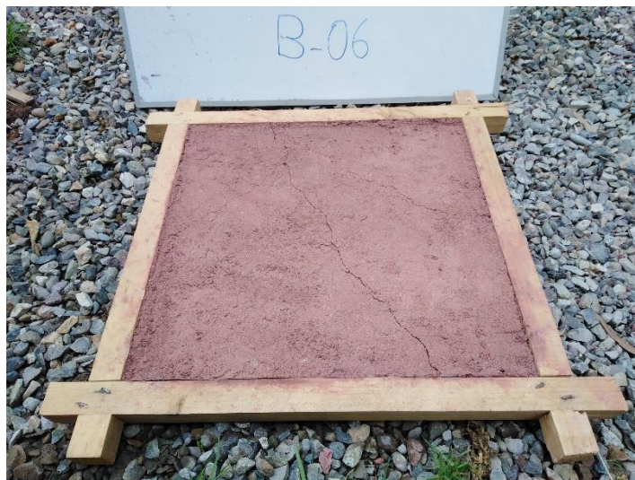
Ilustración 6: En el panel se evidencia un fisuramiento diagonal a lo largo de todo el panel, no se muestra la vista posterior porque después de la prueba de goteo se desmoronó
