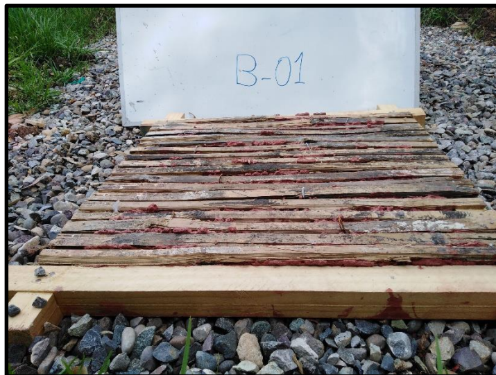
Ilustración 1: Panel B-01 de cañas en sentido horizontal, no presenta fisuras ni agrietamientos el mortero quedo adherido de manera uniforme
