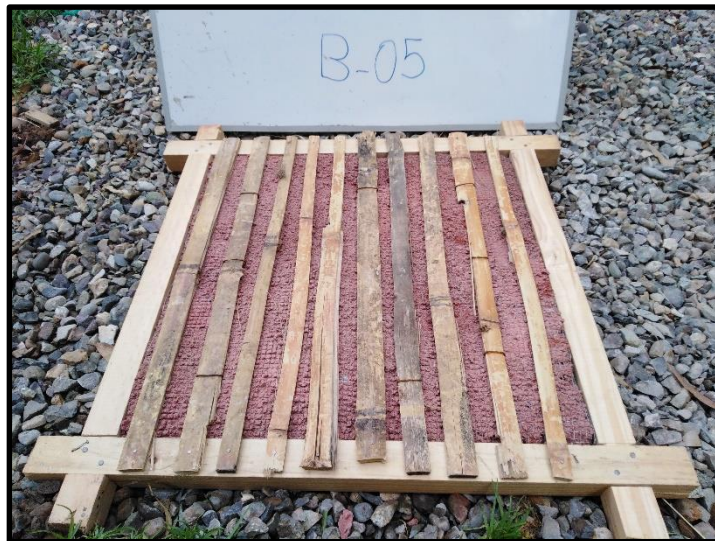
Ilustración 5: Panel B-05 de cañas en sentido vertical , presenta fisuras leves y un agrietamiento diagonal el mortero quedo adherido de manera uniforme, se usó una malla de un cuarto de pulgada
