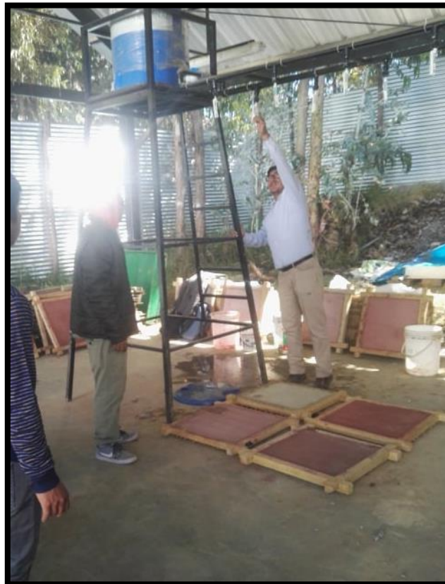
Fotografía 7: Activando la prueba de goteo
