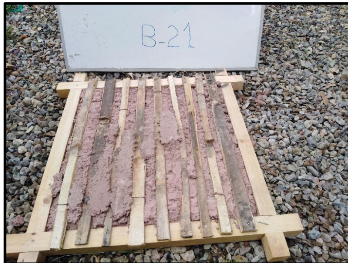
Ilustración 21: Panel B-21 de cañas en sentido vertical , no presenta fisura ni agrietamiento el mortero quedo adherido de manera uniforme, atravesó y envolvió las cañas , se usó una malla cuadrada de media pulgada, la mezcla usada contenía el porcentaje de humedad adecuado.
