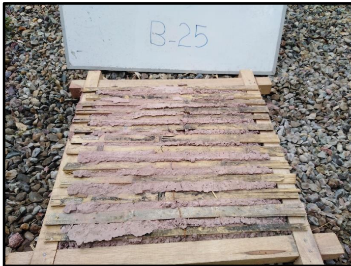
Ilustración 25: Panel B-25 de cañas en sentido horizontal , no presenta fisuras ni agrietamientos el mortero quedo adherido de manera uniforme, atravesó y envolvió las cañas de forma adecuada , se usó una malla de media pulgada, la mezcla usada contenía el porcentaje de humedad adecuadas.
