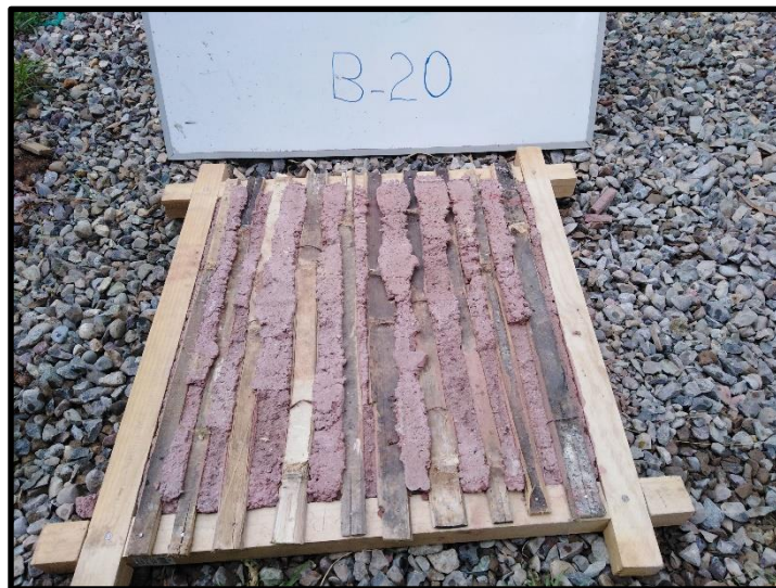
Ilustración 20: Panel B-20 de cañas en sentido vertical , presenta una fisura vertical y agrietamientos verticales el mortero quedo adherido de manera uniforme, atravesó y envolvió las cañas , se usó una malla cuadrada de media pulgada, la mezcla usada contenía el porcentaje de humedad.
