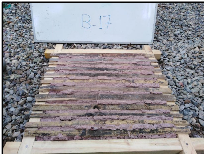
Ilustración 17: Panel B-17 de cañas en sentido horizontal , no presenta fisuras ni agrietamientos en general el mortero quedo adherido de manera uniforme, se usó una malla cuadrada de media pulgada, la mezcla usada contenía el porcentaje de humedad adecuado
