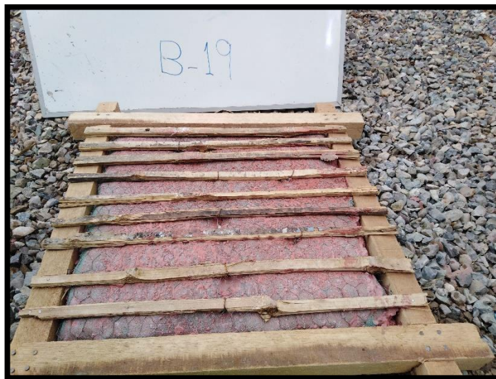
Ilustración 19: Panel B-19 de cañas en sentido horizontal , presenta fisuras y agrietamientos en general el mortero no quedo adherido de manera uniforme, porque se usaron dos mallas ,una malla hexagonal y una malla mosquitero , que no permitieron que la mezcla envuelva a las cañas limitando su adherencia.
