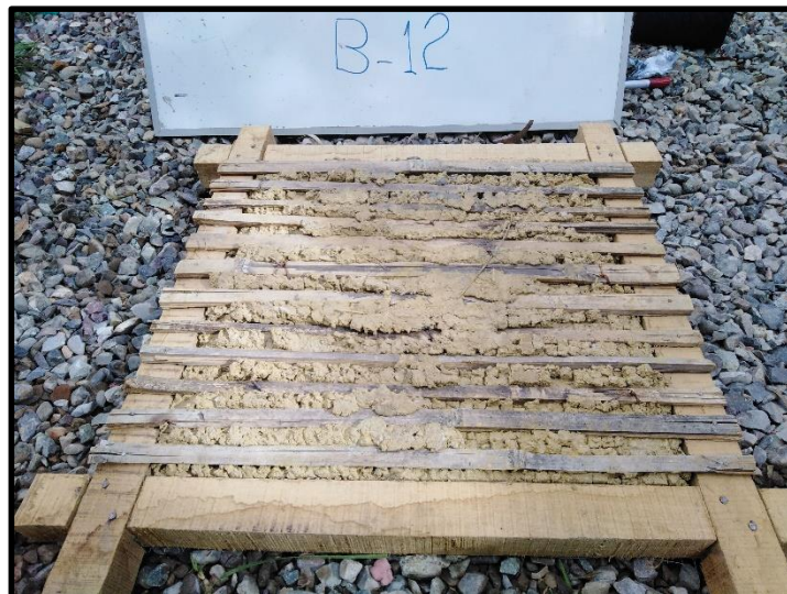
Ilustración 12: Panel B-12 de cañas en sentido horizontal , presenta fisuras leves y agrietamientos en el centro del panel el mortero quedo adherido de manera uniforme, se usó una malla de media pulgada, la mezcla usada no se homogenizo adecuadamente
