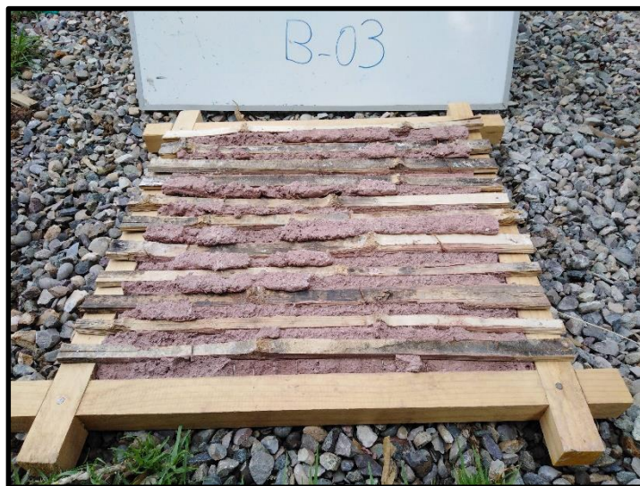
Ilustración 3. Panel B-03 de cañas en sentido horizontal las cañas esta fijadas por el lado liso hacia el interior, no presenta fisuras ni agrietamientos el mortero quedo adherido de manera uniforme en la parte posterior se desbora el mortero .
