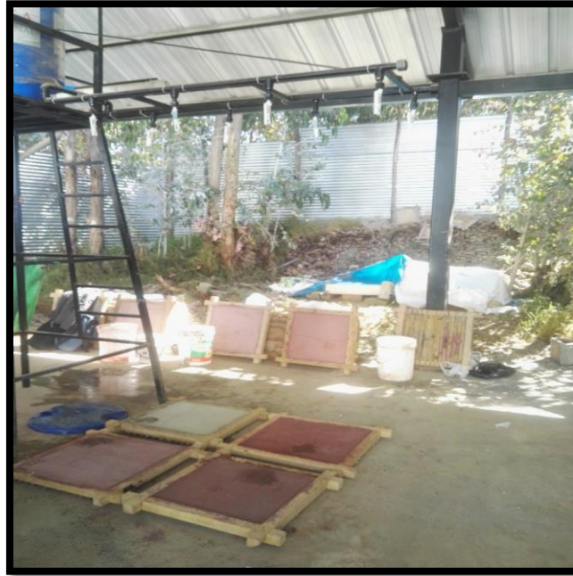
Fotografía 7: Activando la prueba de goteo
