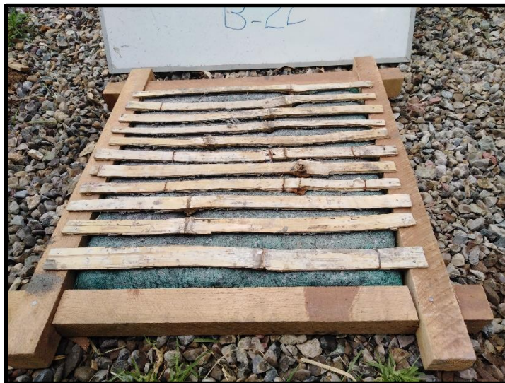
Ilustración 22: Panel B-22 de cañas en sentido horizontal , no presenta fisuras ni agrietamientos el mortero quedo adherido de manera uniforme, pero no atravesó las cañas , se usó una malla de tipo mosquitero , no se logró que el mortero envuelva a las cañas .
