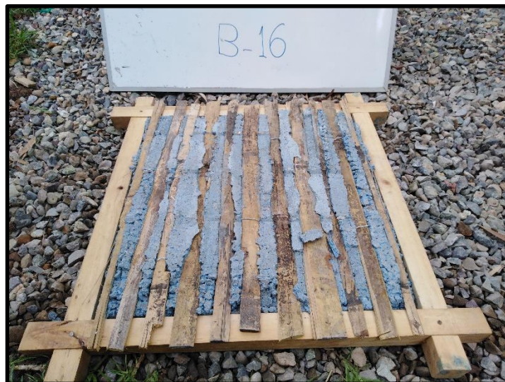
Ilustración 16: Panel B-16 de cañas en sentido vertical , no presenta fisuras ni agrietamientos en general el mortero quedo adherido de manera uniforme, se usó una malla de media pulgada, la mezcla usada contenía el porcentaje de humedad adecuado.
