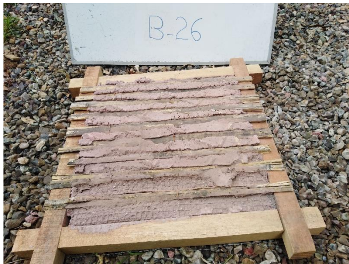
Ilustración 26: Panel B-26 de cañas en sentido horizontal , presenta una fisura y agrietamiento horizontal profundo el mortero quedo adherido de manera uniforme, atravesó las cañas y las envolvió , se usó una malla de media pulgada, la mezcla usada contenía el porcentaje de humedad adecuado.
