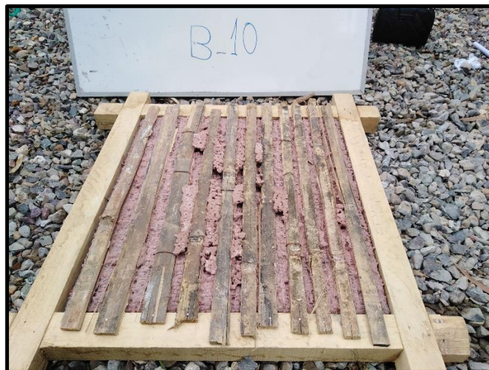
Ilustración 10: Panel B-10 de cañas en sentido vertical , no presenta fisuras y un agrietamiento en la esquina inferior el mortero quedo adherido de manera uniforme, se usó una malla de un cuarto de pulgada, el mortero envuelve adecuadamente a las cañas
