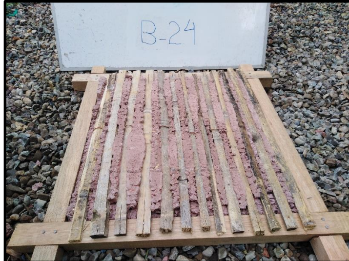
Ilustración 24: Panel B-24 de cañas en sentido vertical , presenta una fisura y agrietamiento vertical el mortero quedo adherido de manera uniforme, pero atravesó las cañas de manera parcial , se usó una malla de media pulgada, la mezcla usada contenía el porcentaje de humedad adecuado.
