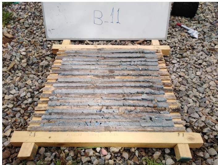
Ilustración 11: Panel B-11 de cañas en sentido horizontal , presenta fisuras leves y agrietamientos en general el mortero quedo adherido de manera uniforme, se usó una malla de un cuarto de pulgada, la mezcla usada contenía agua en abundancia.
