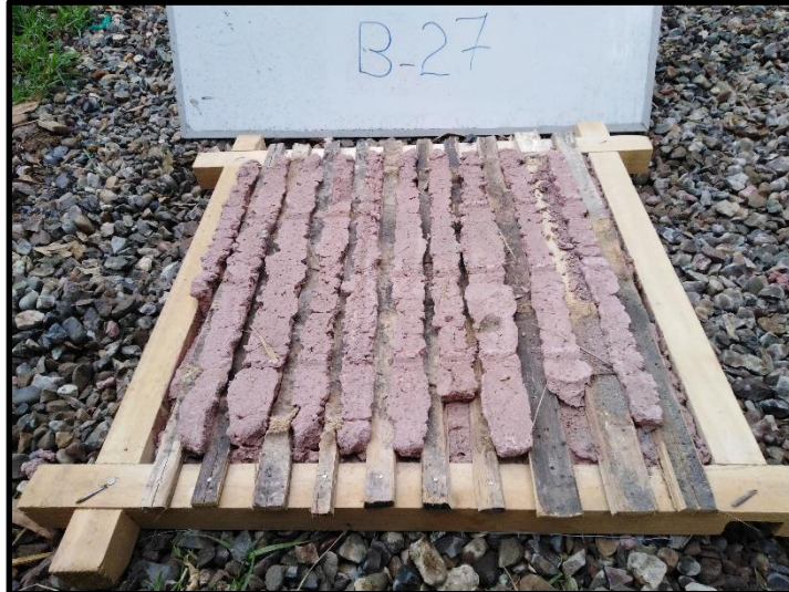
Ilustración 27: Panel B-27 de cañas en sentido vertical , presenta una fisura y agrietamiento horizontal el mortero quedo adherido de manera uniforme, el mortero atravesó las cañas , se usó una malla de \frac{3}{4} de pulgada, la mezcla usada contenía el porcentaje de humedad adecuado.
