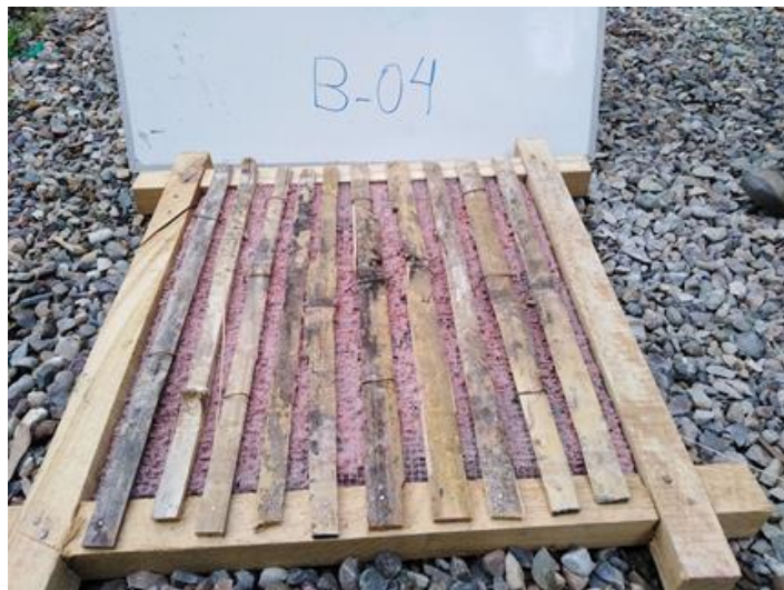
Ilustración 4: Panel B-04 de cañas en sentido vertical, no presenta fisuras ni agrietamientos el mortero quedo adherido de manera uniforme, se usó una malla de \frac{1}{4} de pulgada las cañas se fijaron con el lado poroso hacia el mortero, esto permitió una buena adherencia .
