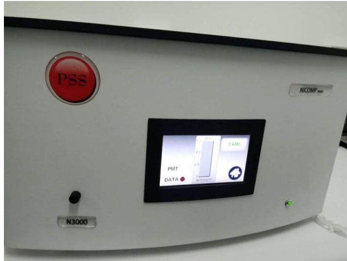
Figura 05. Equipo DLS NICOMP PSS Z3000 utilizado para la determinación del tamaño de las nanopartículas de TiO 2 .
