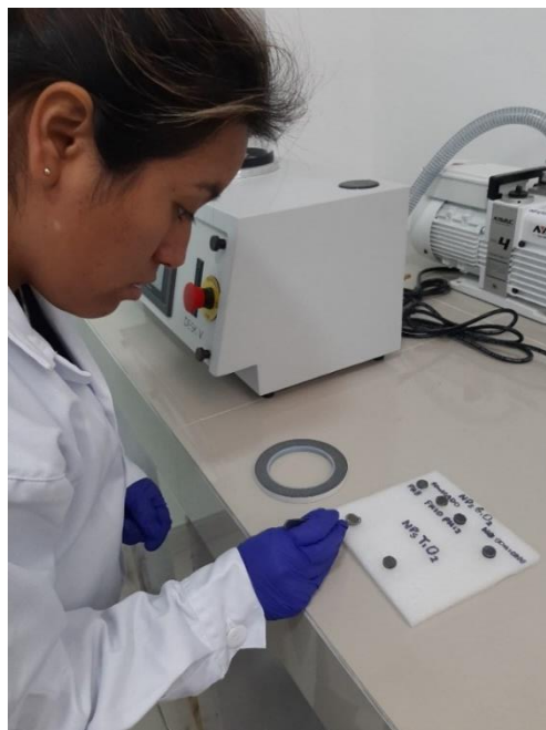
Fotografía 13. Metalización de las muestras de NPs-TiO 2 para el análisis en el SEM.
