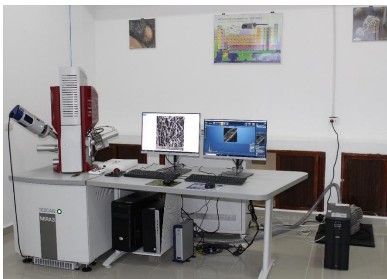
Figura 06. Equipo de Microscopia Electrónica de Barrido utilizado para la caracterización de la morfología y composición de las nanopartículas de TiO 2 .
