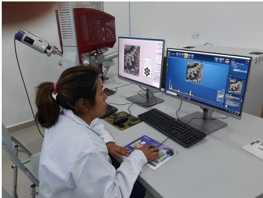
Fotografía 17. Mapeo de la muestra para la determinación de la composición de la muestra de \text{TiO}_2 en el equipo SEM.
