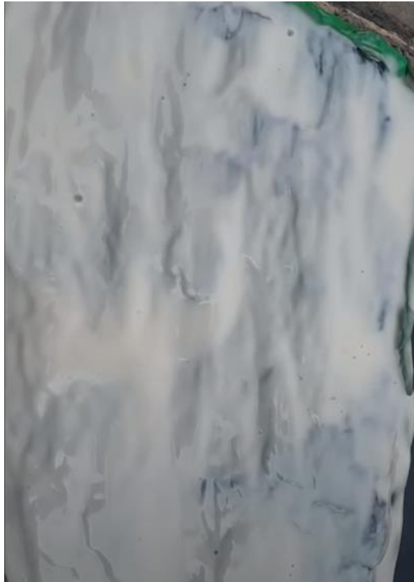
Figura 2.5 Molde en forma de piedra para acabado texturizado, hecho a base de Silicona
