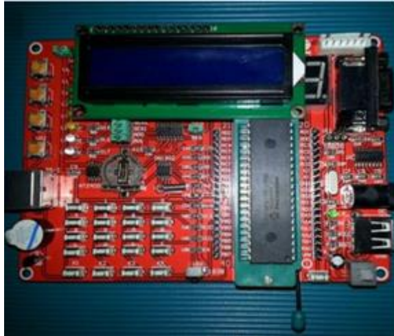
Figura 2.1 Módulo de variación de velocidad PWM en la tarjeta de entrenamiento para microcontrolador PIC, tomada de “Diseño de un sistema de control de velocidad para el motor DC de la pulidora metalográfica modelo 3E881”, por Canelles Michel, 2017, p56.
