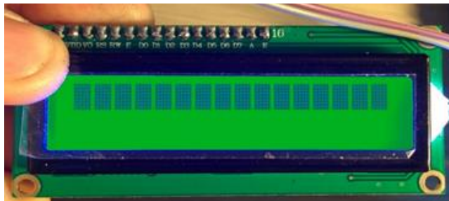
Figura 2.11 Pantalla LCD 2x16 en funcionamiento. Tomado de Fabacademy. Por Fabacademy. 2019
