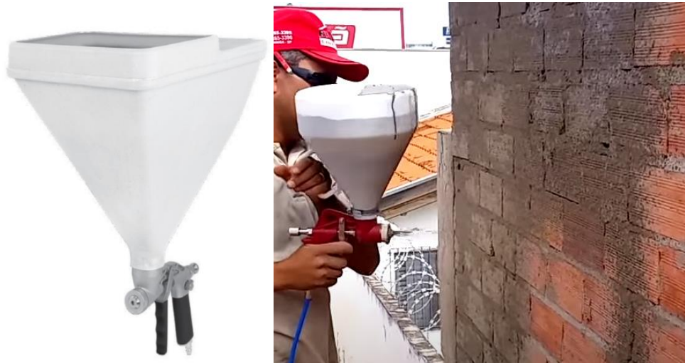
Figura 4.3 Izquierda: Pistola Tipo Tolva Truper para texturizados escarchados. Derecha: Aplicación de escarchado con la pistola Truper PITI 687
