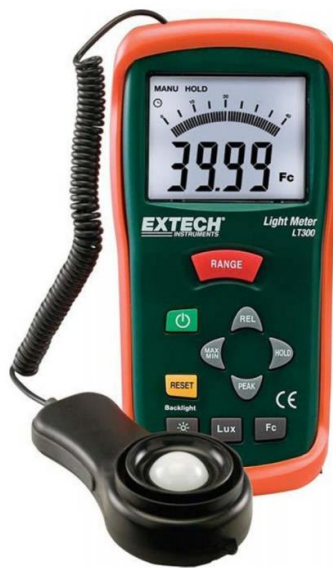
Figura 2: Instrumento de medición. LUXOMETRO. Recuperado de la página web: Agro market.
