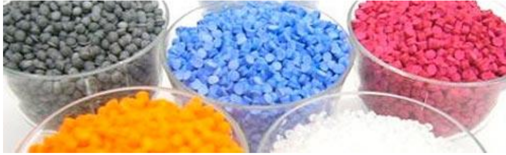
Figura 16 polímeros Termoplásticos. Tomada de «¿Qué es un termoplástico?, Usos y características», por CodeBox. 2019 en: https://bit.ly/340MF1A
