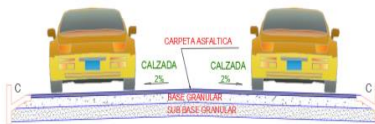
FIGURA N° 3: Corte típico de un pavimento Fuente: (Gutiérrez, 2007)
