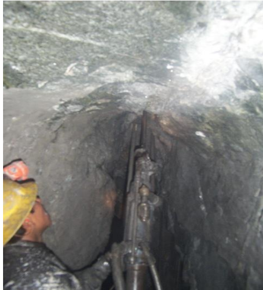
Figura 31: Perforación y voladura en vetas angostas tajo Carmelita, mina Toctopata Fuente. Elaboración propia
