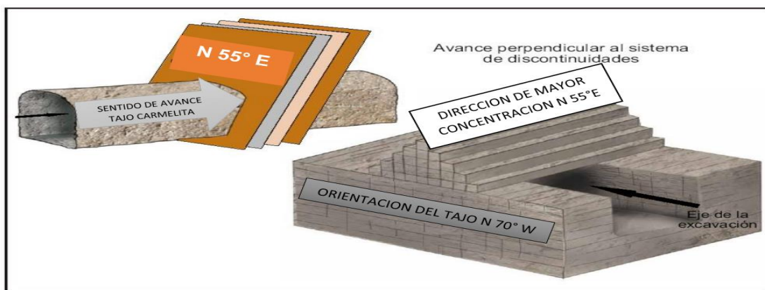
Figura 16: Orientación del tajo respecto a las discontinuidades en mina Toctopata Fuente. Elaboración propia.
