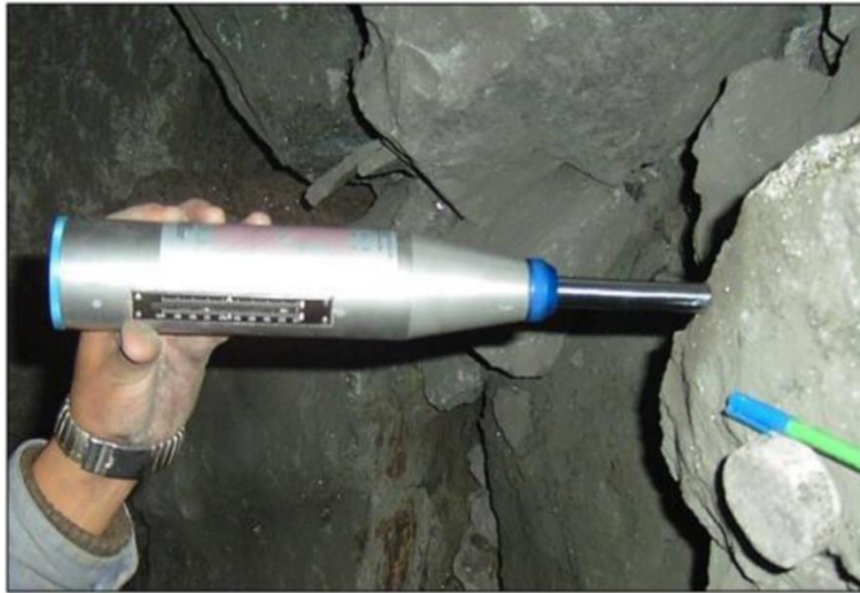
Figura 8: Posición de lectura con esclerómetro Fuente. Rodríguez G. (2015)
