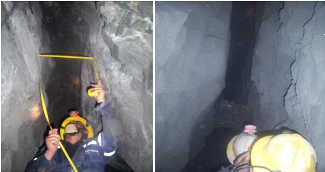
Figura 32: Resultado de voladura de vetas angostas tajo Carmelita mina Toctopata Fuente. Elaboración propia
