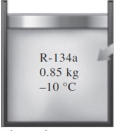
5. Un cilindro-émbolo que contiene 0.85 kg de refrigerante 134a a -10 °C. Se transfiere calor  $Q$  al refrigerante hasta que la temperatura es 15 °C. Determine a) la presión final, b) el cambio de volumen del cilindro y c) el cambio de entalpía en el refrigerante 134a.
