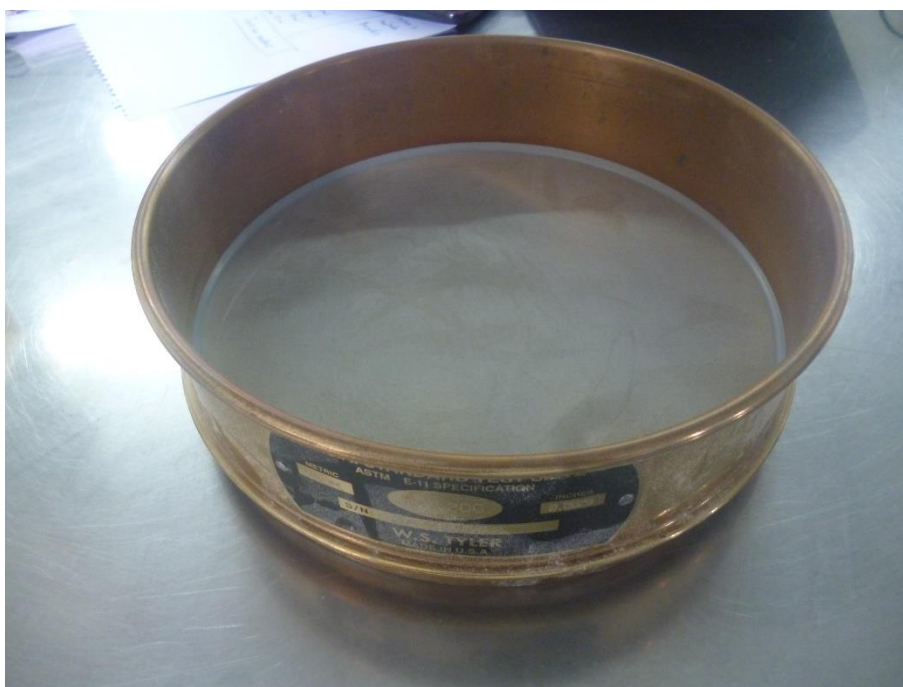
Fotografía N° 14: Tamiz utilizado en la determinación de textura del suelo.
