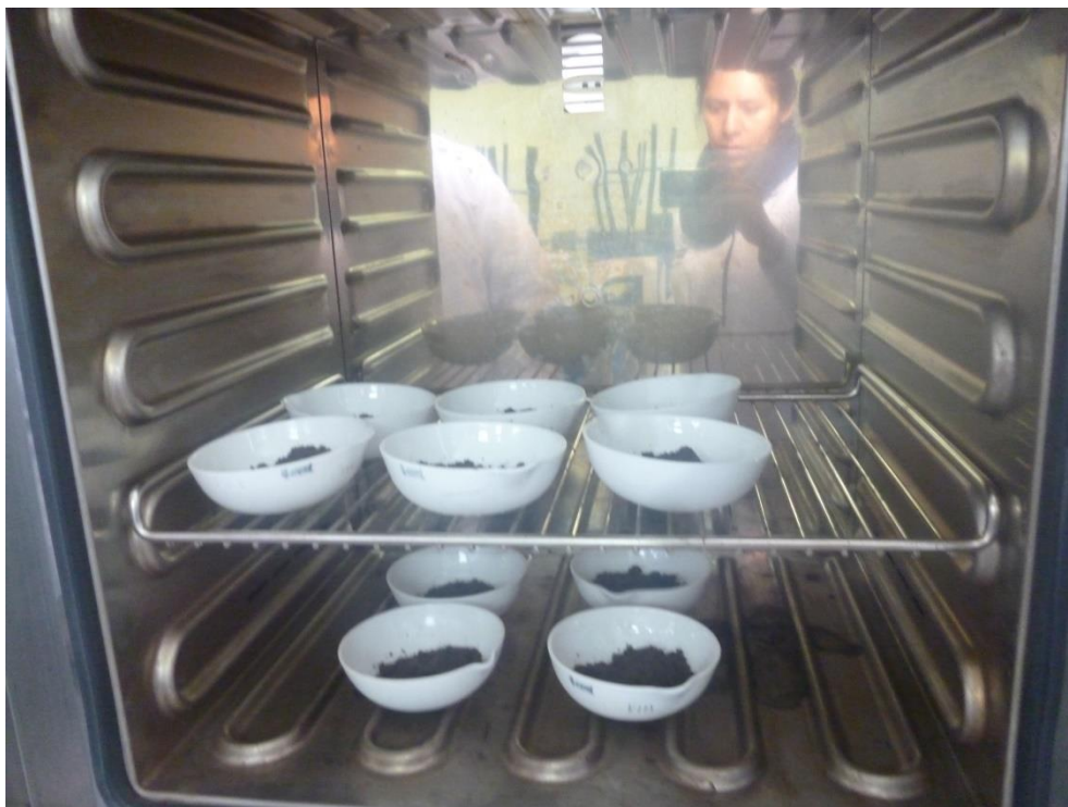
Fotografía N° 12: Estandarización de las muestras a una temperatura y tiempo predeterminado.
