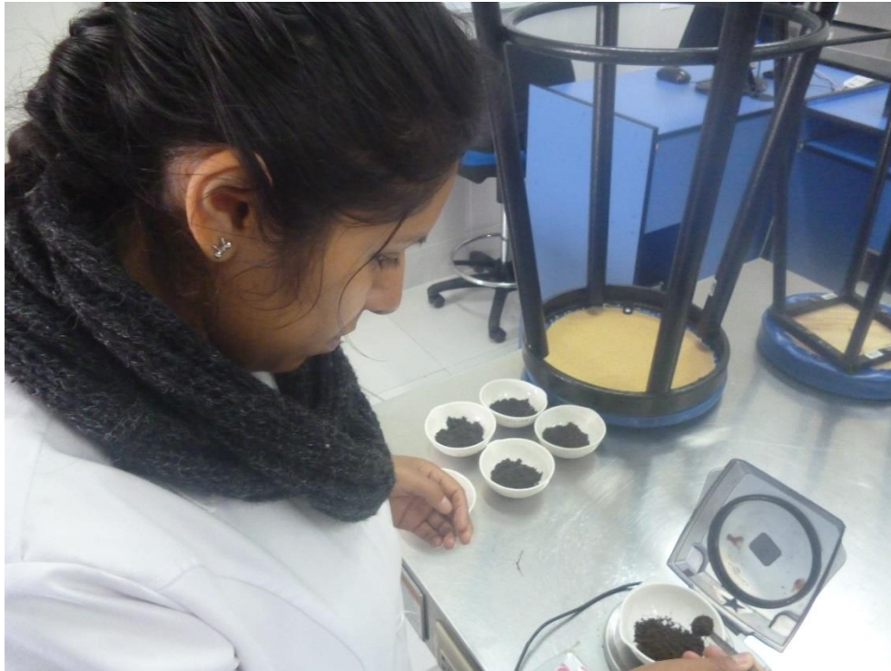
Fotografía N° 11: Determinación de la masa inicial de las sub-muestras de suelo.
