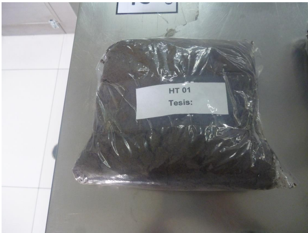
Fotografía N° 08: Ejemplo de la muestra de suelo etiquetada y almacenada óptimamente.
