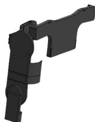
Figura 13 Exoesqueleto codo-muñeca con material PET, Fuente Propia
