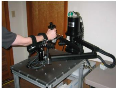
Figura 5 Aplicación de movimiento de flexión-extensión del Inmotion Wrist, IEEE TRANSACTIONS ON NEURAL SYSTEMS AND REHABILITATION ENGINEERING, 2018
