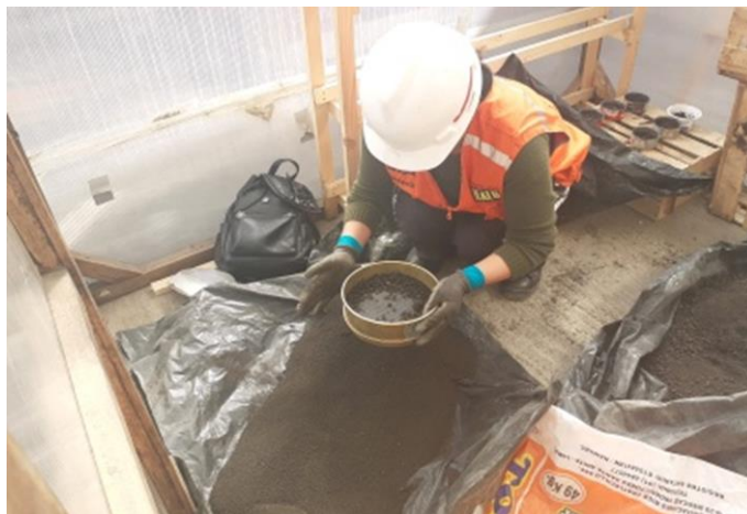
Fotografía 04. Tamizado del suelo contaminado con hidrocarburos.
