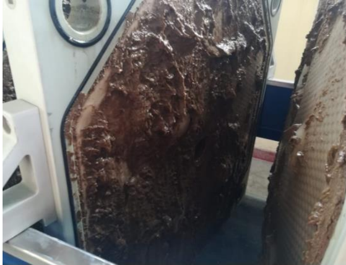
Figura 14. Lodos acuosos sin forma de tortas.
