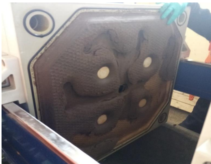
Figura 16. Torta de lodo con poca consistencia - Prueba 1.
