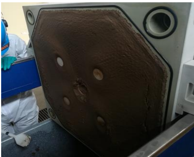
Figura 17. Torta de lodo con buena consistencia - Prueba 2.
