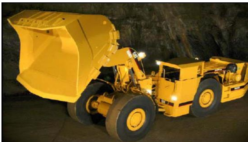
Figura 3. Cargador de bajo perfil Caterpillar R1300G. Tomada de especálogo Caterpillar R1300g
