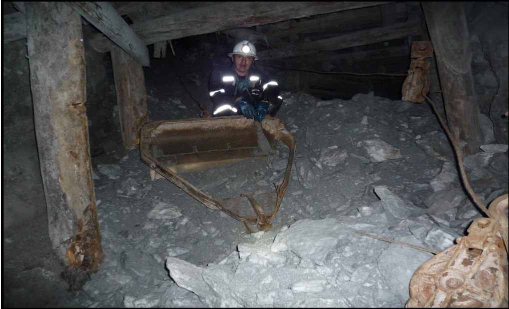
Figura 56. Limpieza en L con rastra de 36", winche de 15 Hp, método de minado Long Wall
