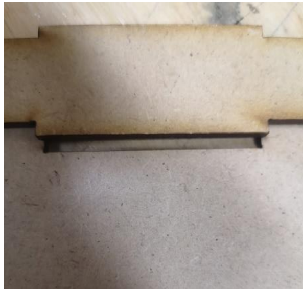
Figura 7: El MDF de 5 milímetros presenta mayor porcentaje de error lo cual nos dificultaba encontrar un buen encaje para que las piezas entren a presión.
