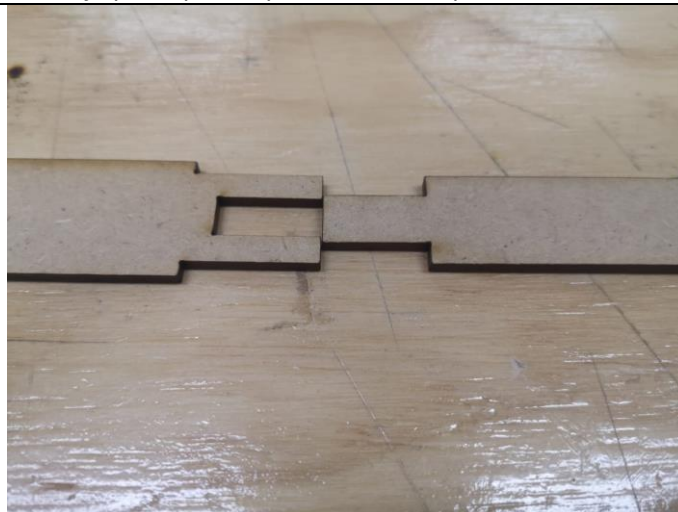
Figura 8: Se observa en la imagen que la pieza no tiene un enganche adecuado para encajar el otra pieza.
