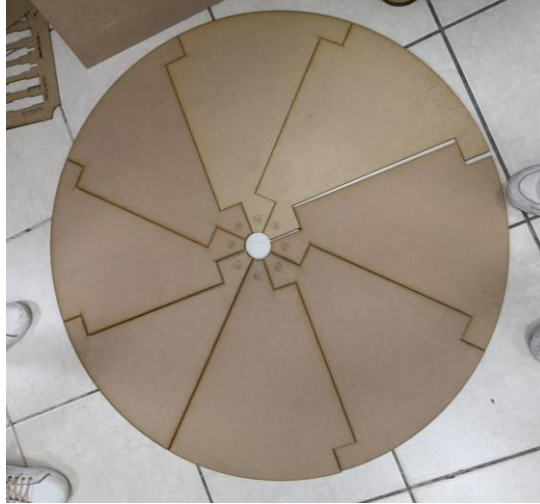
Figura 9: Esta imagen presenta un corte exacto de las piezas lo cual nos permitió ver que las piezas no tenían un encaje a presión.:
