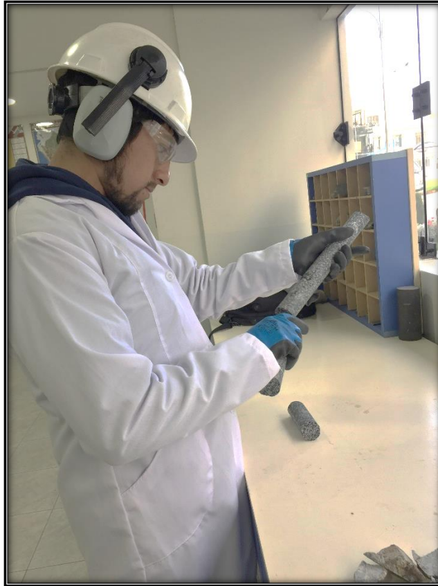
Figura 14: Fotografía de las preparaciones para la prueba de carga puntual.
