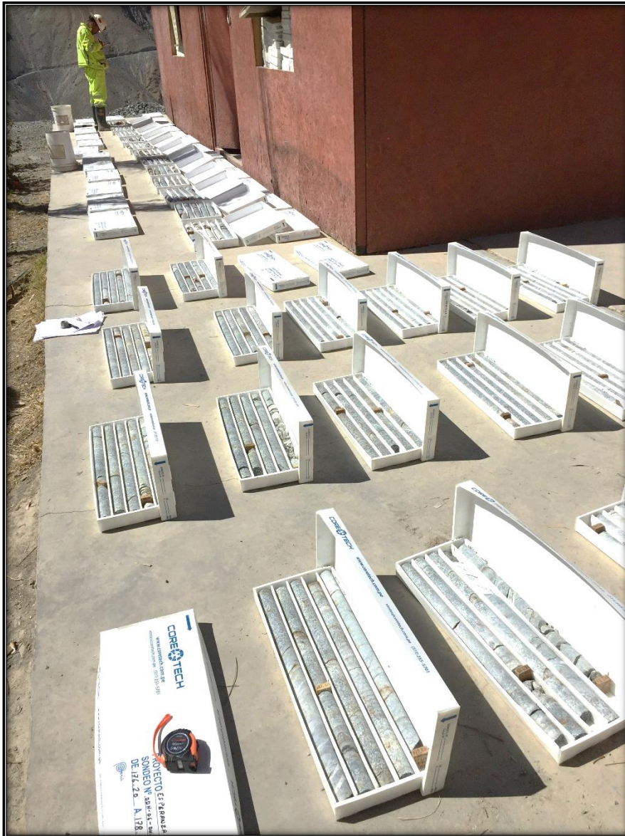
Figura 17: Fotografía de la evaluación del RQD de testigos.
