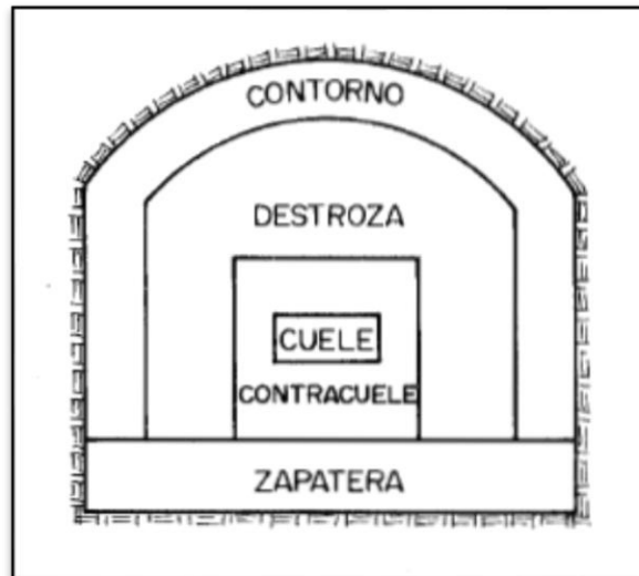
Figura 3: Esquema de voladura en túneles.
