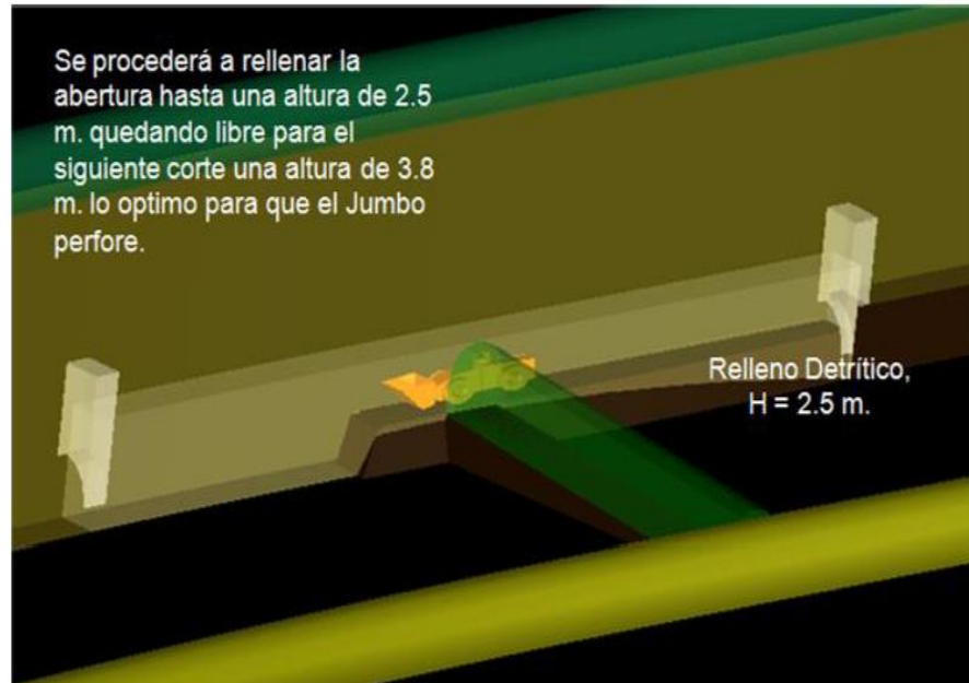
Figura 06. Relleno detrítico luego de culminar la limpieza del primer corte.
