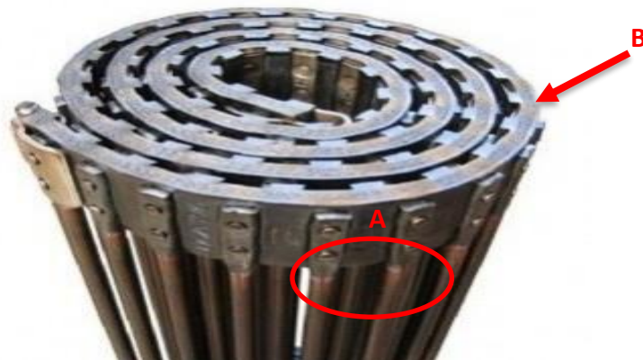
Figura 2.8. A) Distancia fija entre varillas; B) material de lona como base para la unión de las varillas. Adaptada de “sitio web” por Beltec (26 pág. 1)
