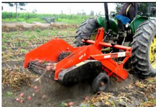
Figura. 1.4 Cosechadora de papa modelo CP-1. Tomado de “google groups” por Sermi Implementos Agrícolas. (6 pág. 2)
