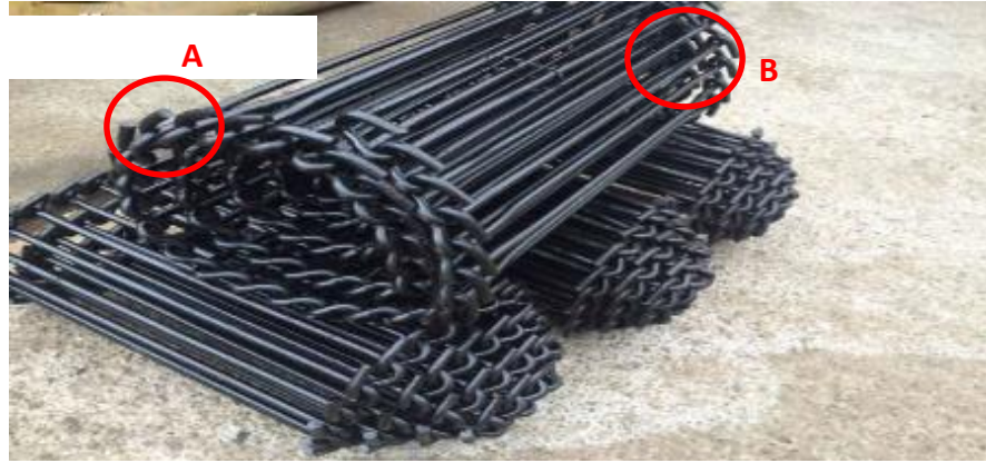
Figura 2.7. A) Área filosa en donde se genera daño por magulladura; B) Zona de la unión articulada de los eslabones. Adaptada de “sitio web” por Agrícola Castelao (25 pág. 1)
