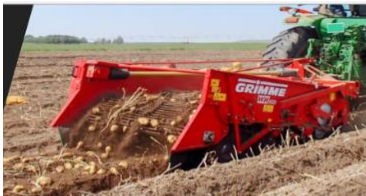
Figura. 4.1 Cosechadora de papa de dos hileras modelo WH-200. Tomado de “Fabrica de Maquinaria Agrícola Grimme” por Grimme (41 pág. 2)
