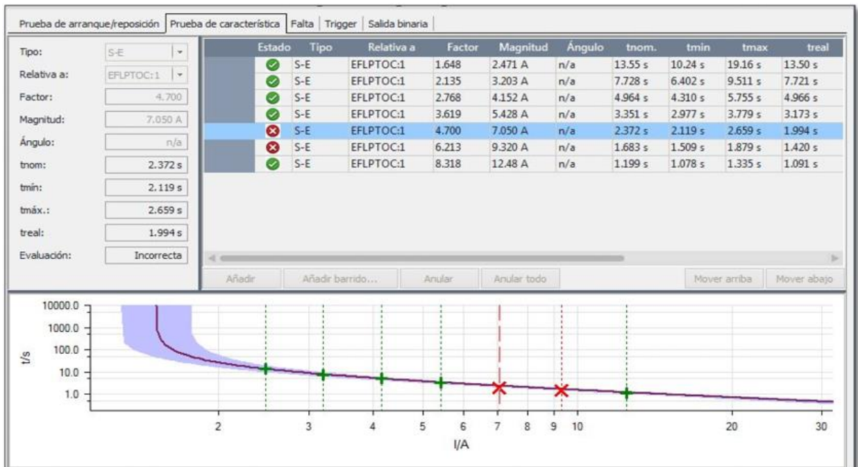
Figura 11: Desviación de protección 50N para el relé de barra de 22.9kV.
