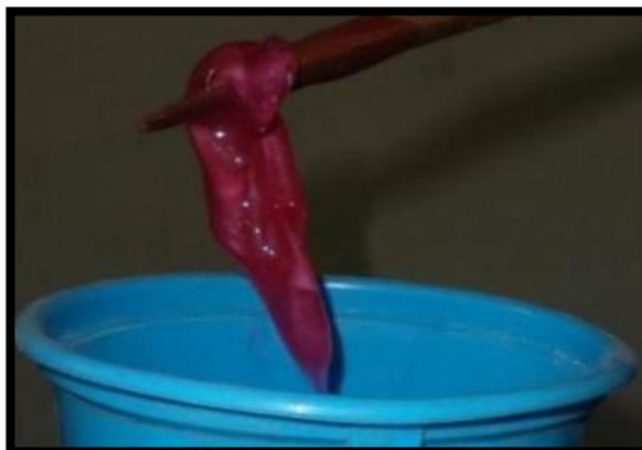
Figura N° 16. Formación de grumos por una mala agitación de los artículos "BRISSOL" de la empresa Corvel's S.R.L.
