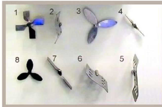
móviles de agitación: tipo hélice (1,3,8), tipo planos (2,5,8), tipo hélice inclinado (4,7)
