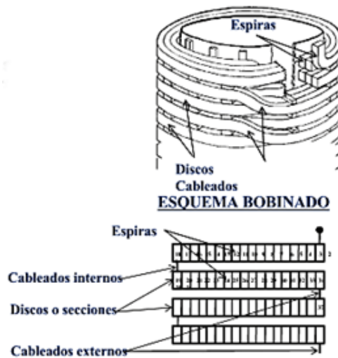
Figura 20. Bobina tipo de disco continuo. Tomada de “Devanados de Transformadores”, por Granero. 2016, p. 4.
