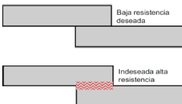
Figura 25. Variación de resistencia por cambios en la superficie de contacto. Tomada de “Pruebas Eléctricas para Transformadores de Potencia”, por Megger, 2012. p. 19.
