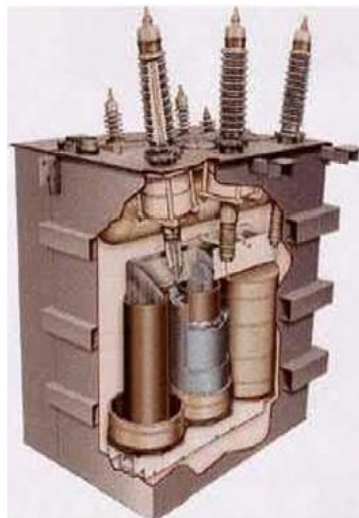
Figura 36. Transformador de potencia – Corte interno. Tomada de “Pruebas de Factor de Potencia/Disipación”, por Megger, 2012. p. 17.
