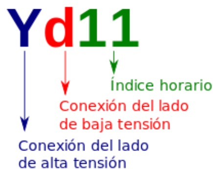
Figura 7. Ejemplo de grupo de conexión. Tomada de “Grupo de Conexión”, Wikipedia. 2015.
