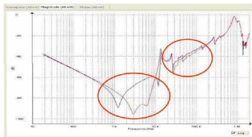
Figura 51. Diferencias en las curvas obtenidas en el ensayo SFRA. Tomada de “Técnicas modernas de diagnóstico en transformadores de potencia”, por Megger. 2011, p. 45.
