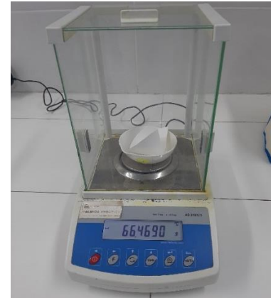
Fotografía 43. Peso inicial de filtro + capsula de porcelana para determinación de Sólidos Suspendedos Totales.
