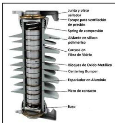
**Figura 19. Partes de un pararrayo**
