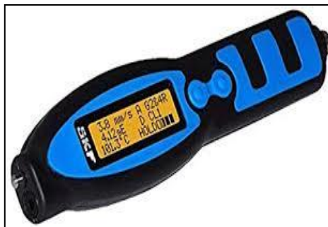
Ilustración 25: Vibro Pen (SKF) Fuente: Mitchell Instrument, s.f.
