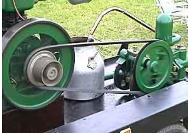
Figura 21. Transmisión de Potencia por fajas, tomado de https://slideplayer.es/slide/10598954/
