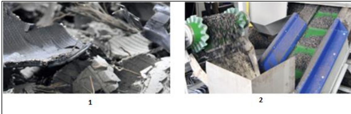
Figura 28. Trozos de 2da etapa de triturado (1), migas de caucho 3ra etapa (2), tomada de http://www.zermamexico.com/
