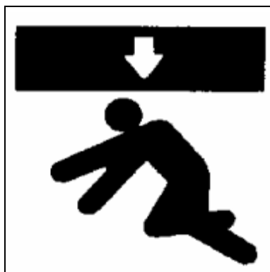
Figura 88. Etiqueta de no ubicarse bajo carga suspendida
