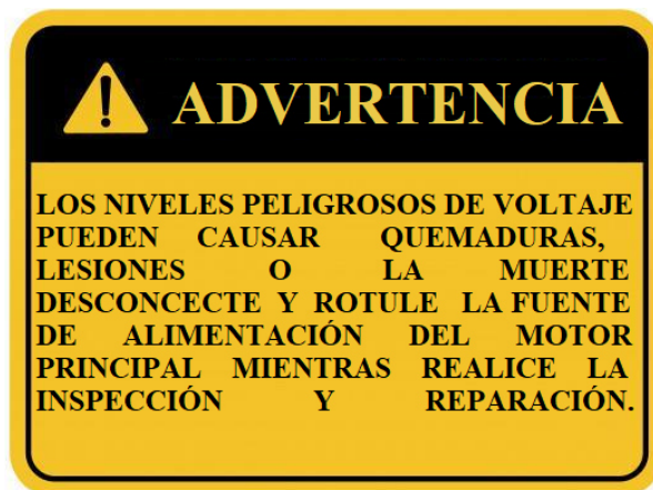
Figura 80. Etiqueta de advertencia peligro por voltaje
