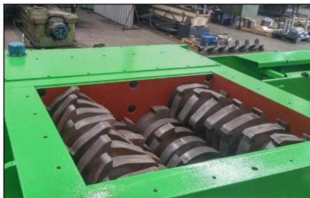
Figura 32. Máquina trituradora de 3 ejes horizontales tomada de https://satrindtech.com/es/triturador-industrial-3-ejes-serie-3r-125/
