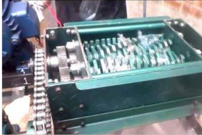
Figura 2. Trituradora con cuchillas de doble corta todo tipo de plásticos, papeles, cartones y residuos de todo tipo adaptado de https://www.youtube.com/watch?v=WoLmW4WtfGc
