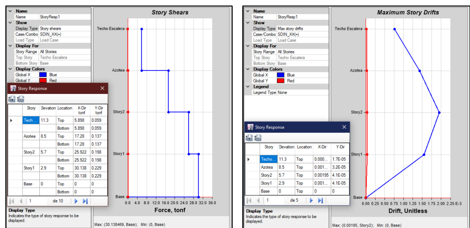
Figura 42: Gráfica de las Fuerzas Sísmicas para un Análisis Estructural Estático en la dirección X (Izquierda) y la Gráfica de los Máximos Desplazamientos en cada Nivel para un Análisis Estructural Dinámico en la misma Dirección (Derecha).
