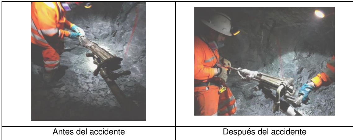
Figura 3. Accidente incapacitante 3 - Causa: empalme de barreno en taladro Fuente: Flash Resport – Alfa S. A.
