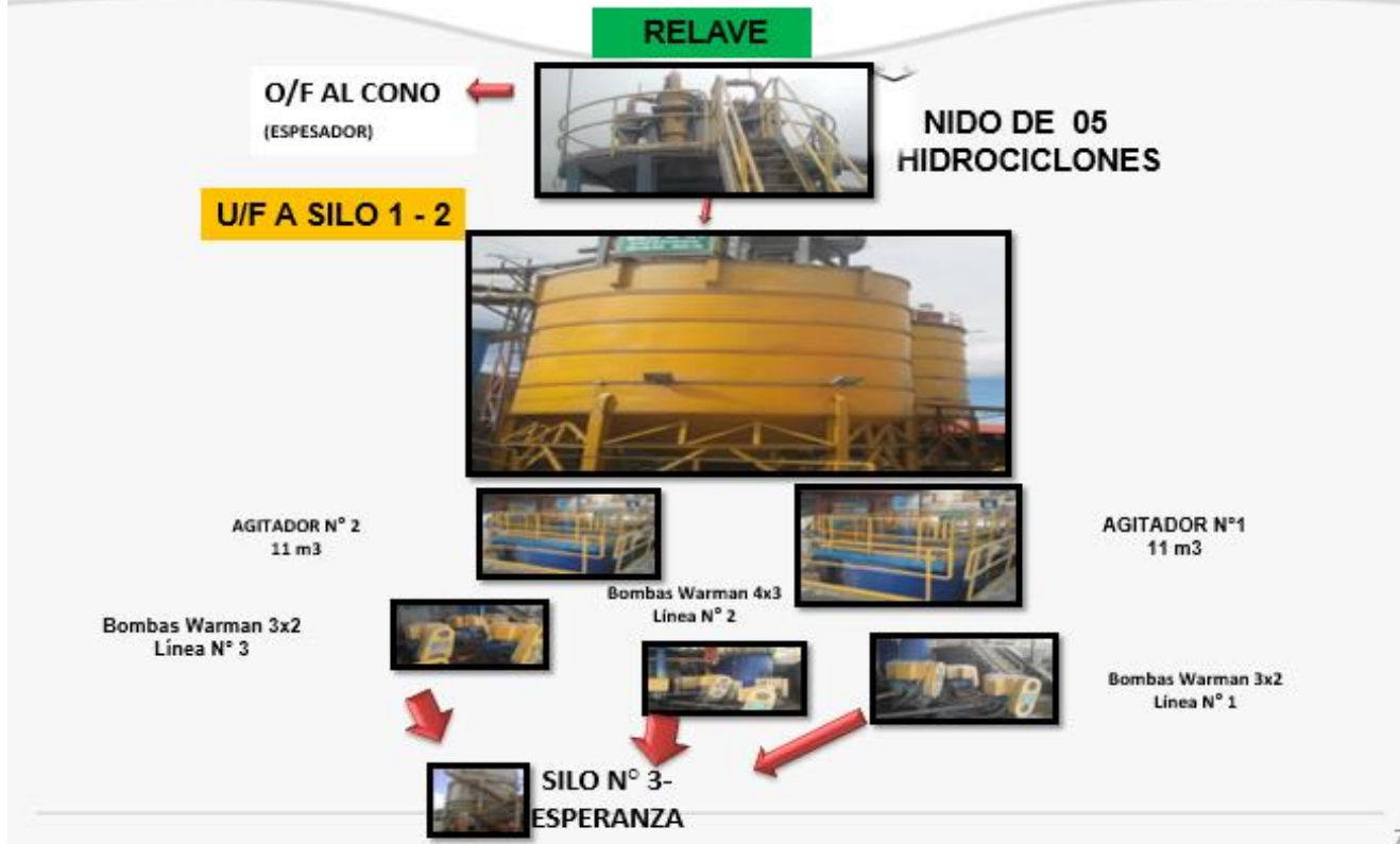
Figura 12. Diagrama de flujo del proceso de relleno hidráulico, planta Montenegro, unidad minera Chungar
