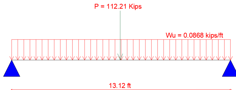
Figura 133: Idealización de viga metálica
