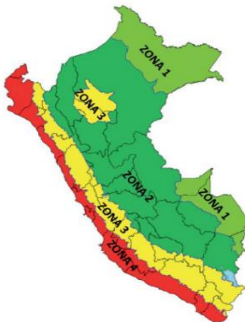
Figura 40: Mapa de zonificación sísmica Fuente: Norma E.030 – Diseño sismorresistente (2018)
