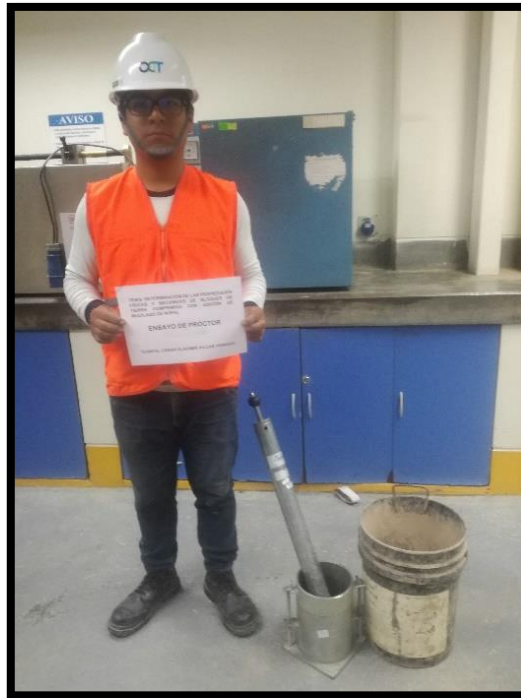
Figura 14. Ensayo de Proctor estándar: Equipos y materiales
