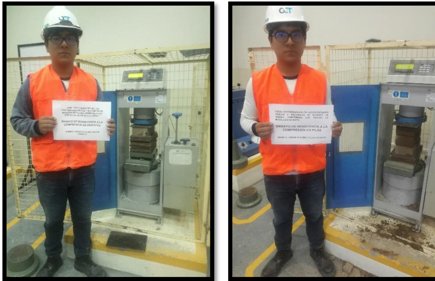
Figura 19. Ensayo de Resistencia a la compresión: Unidad (izquierda); Pila (derecha)
