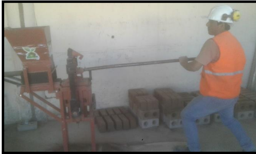
Fotografía 11. Prensado de BTC mediante máquina mecánica.
