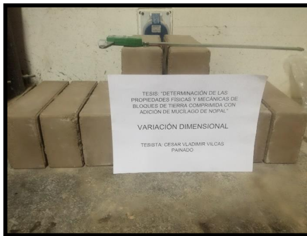
Figura 16. Ensayo de variación dimensional de BTC
