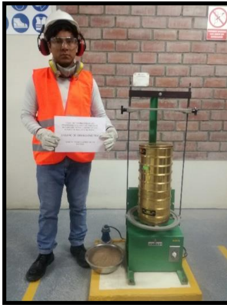
Figura 11. Ensayo de granulometría: Tamizado mecánico
