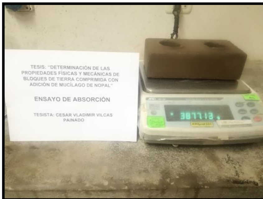
Figura 18. Ensayo de Absorción: Pesaje de espécimen saturado
