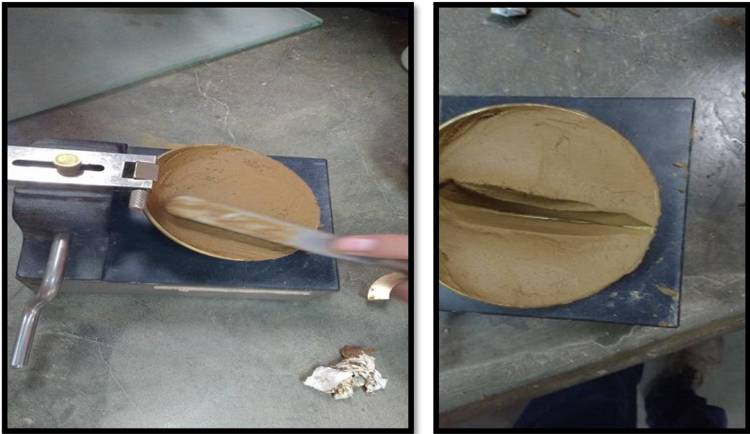
Figura 12. Ensayo de límite líquido: Enrasado (izquierda) y Ranurado (derecha)
