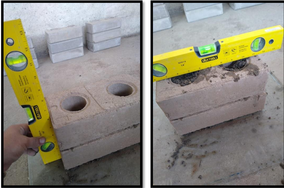
Fotografía 16. Nivelación de la pila
