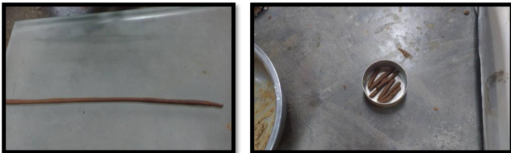
Figura 13. Ensayo de límite plástico: Formación de cilindros (derecha) y encapsulado (izquierda)
