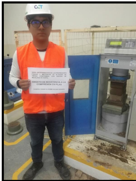
Fotografía 17. Ensayo de Resistencia a la compresión de pilas
