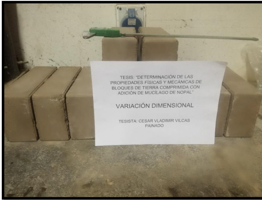
Fotografía 14. Ensayo de Variación dimensional
