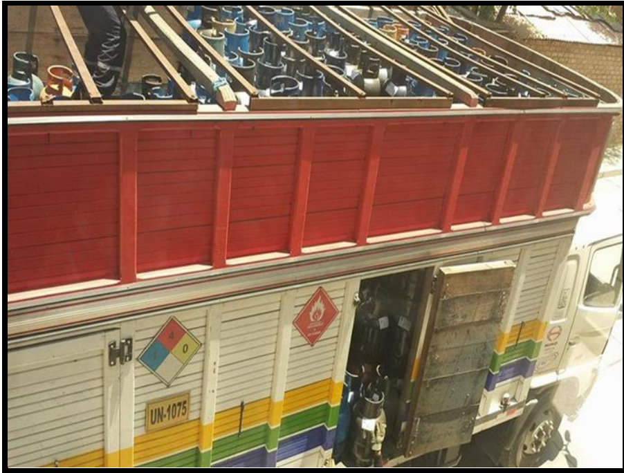
Descarga de balones de gas en almacén
