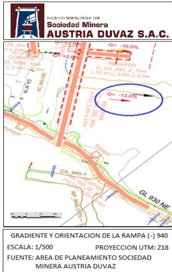
Figura 7. Gradiente y orientación de la rampa (-) 940 Tomado del área de Planeamiento sociedad minera Duvaz S. A. C.
