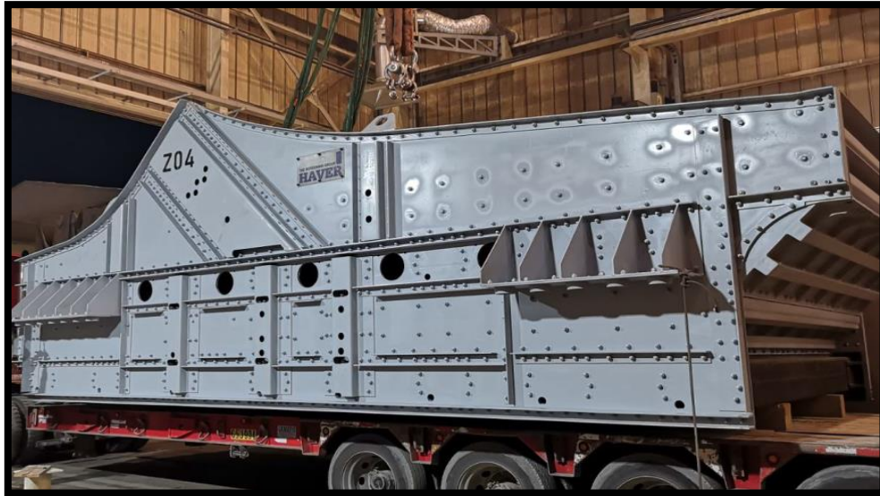
Figura N°14. Armado y reparación de zarandas
