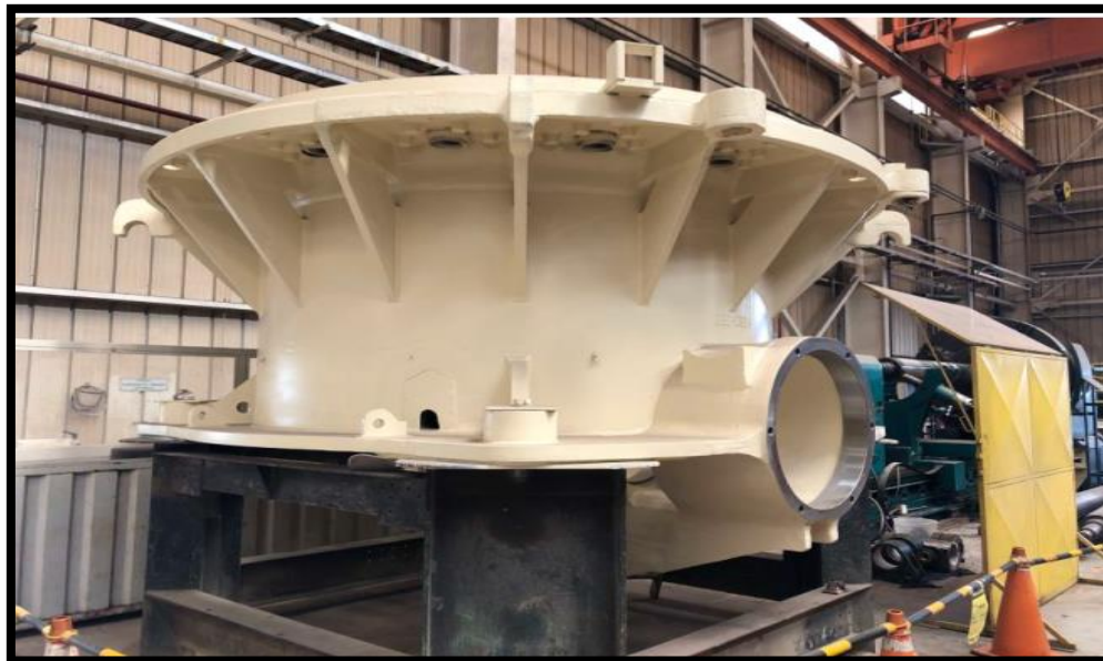
Figura N°15. Armado y reparación de chancadoras
