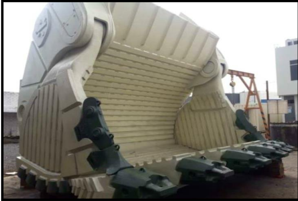
Figura N°16. Armado y reparación de palas
