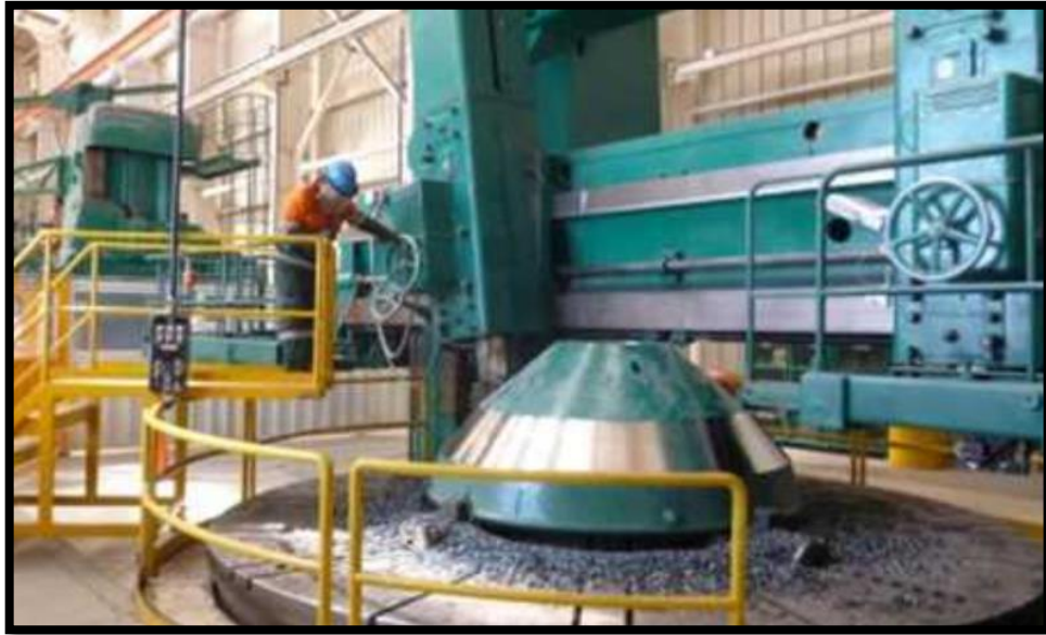
Figura N°12. Reparación de componente en Torno vertical
