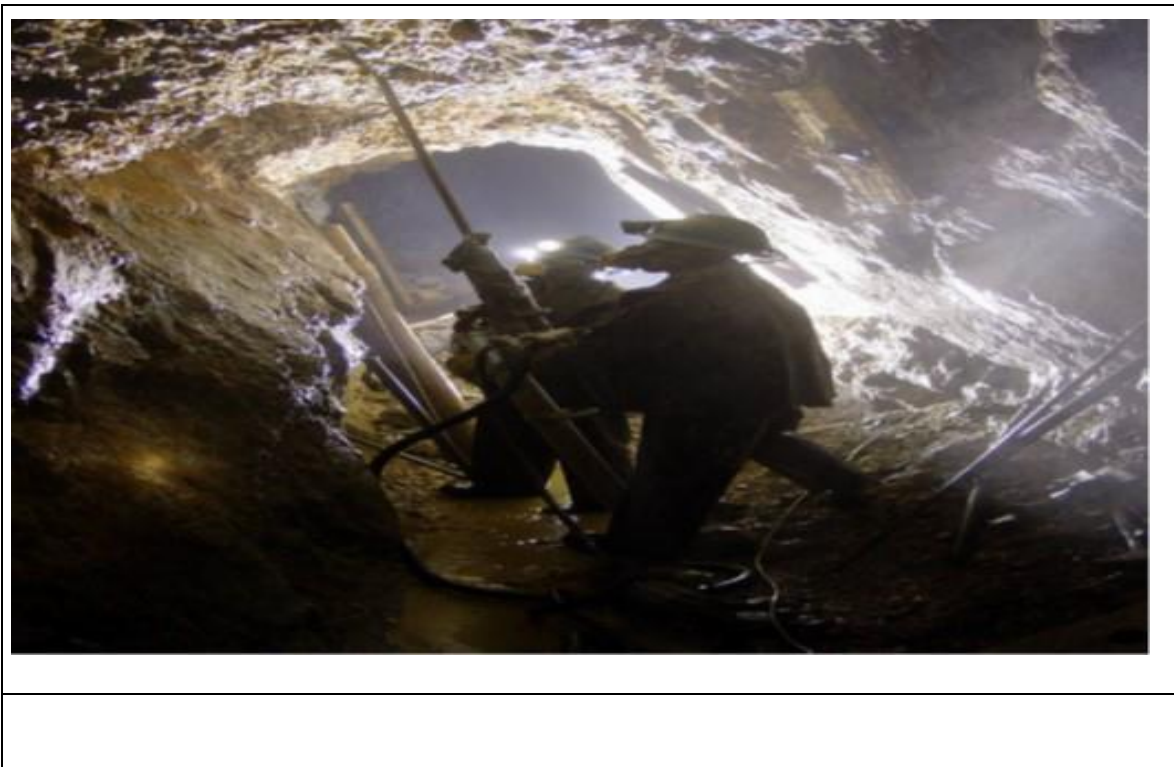
Figura 10. Fotografía de perforación en tajo, método (Over Cut and Fill). Tomado de “Over Cut and Fill”, por J. Valencia, 2015 .
