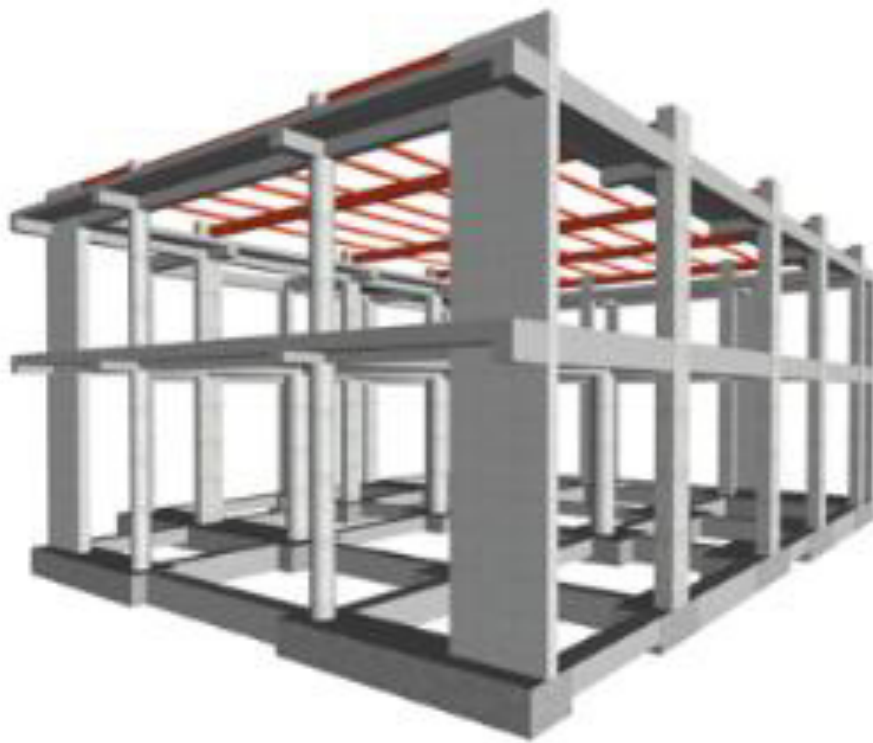
Figura 86. Vista 1 en 3D, propuesta 2, muros en X, pórticos en Y
