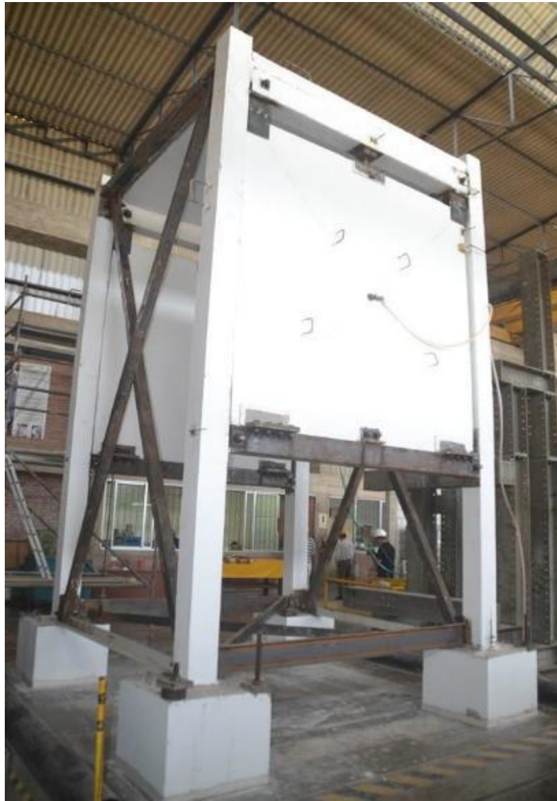
Figura 12. Módulo prefabricado de Concreto armado y con disipadores sísmicos Tomada de Trabajo de Grado UPC Barcelona TECH, Bozzo, 2018
