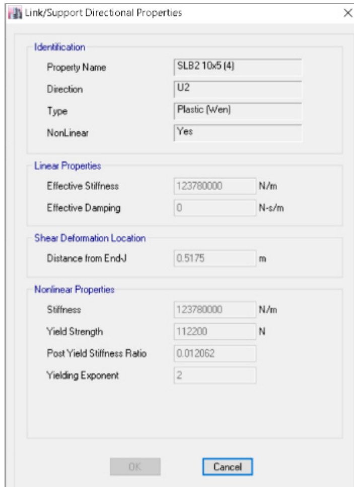
Figura 112. Asignación de los parámetros no lineales a dispositivos SLB
