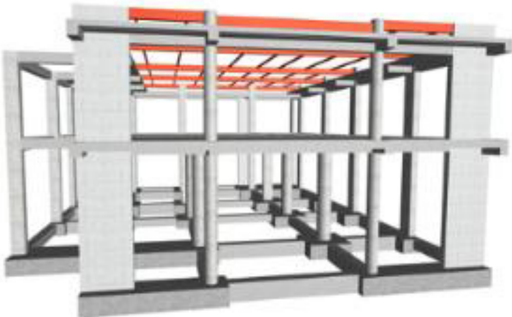
Figura 87. Vista 2 en 3D, propuesta 2, muros en X, pórticos en Y
