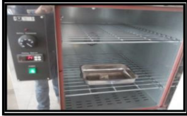
Figura 22. Proceso de secado de las muestras
