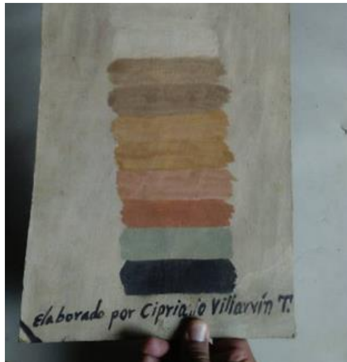
Figura 7: Tonalidades naturales de suelos arcillosos y sus niveles granulométricos
