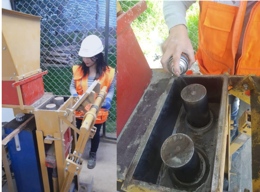
Fotografía 21: Limpieza de la maquina con aceite en spray
