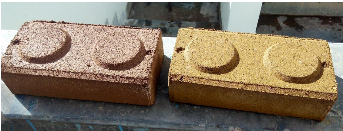
Fotografía 29: Bloques macizos que evidencian la diferencia cromática entre suelos de diferentes canteras
