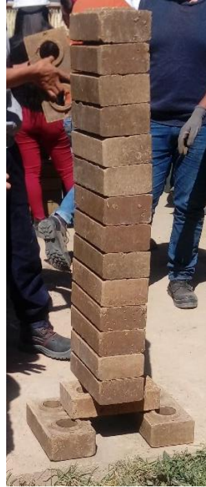
Fotografía 27: Ensayo de resistencia
