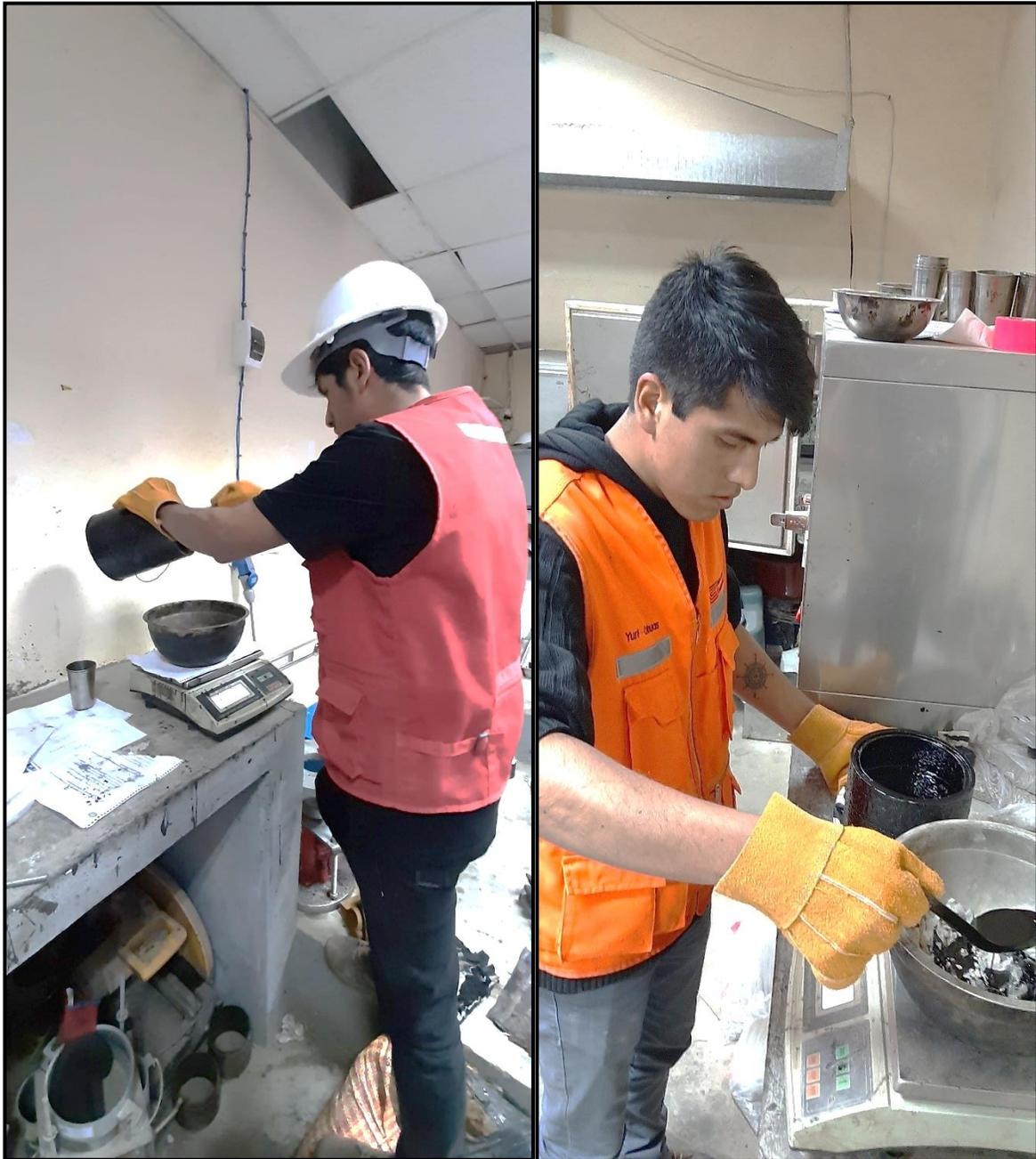
**Anexo 2.9:** Mezcla del agregado, asfalto y fibra de polipropileno
